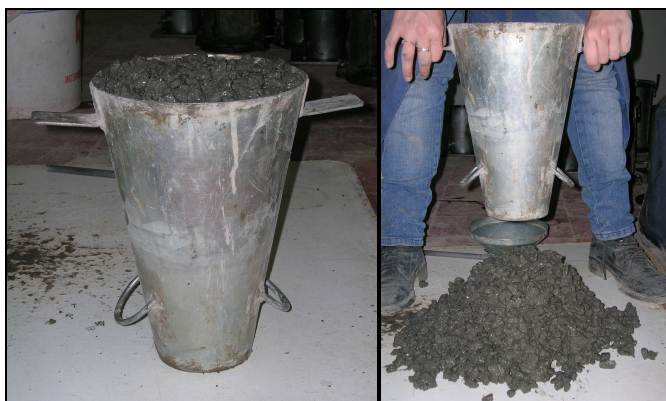
Figura IV-6. Ensayo de Tronco de cono de Abrams invertido para la serie K
