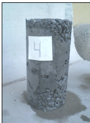
Figura IV-15. Segregación de la pasta probeta serie G.
