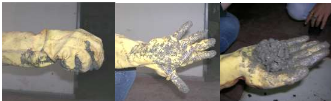
Figura III-2. Método de Hand-Squeeze serie K
