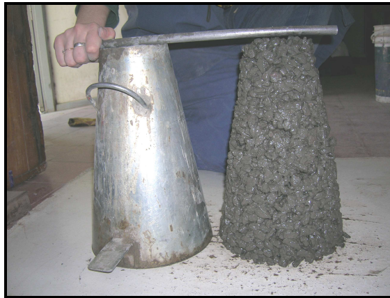
Figura IV-7. Ensayo de asentamiento para la serie K
