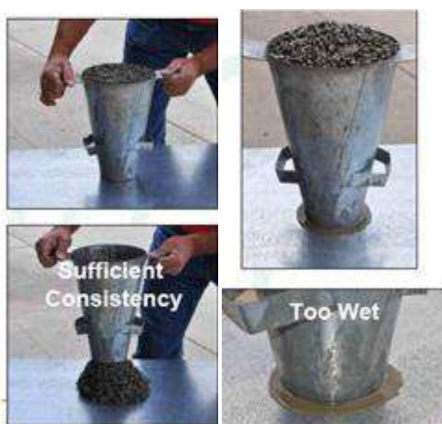
Figura III-3. Ensayo de Tronco de cono de Abrams invertido
