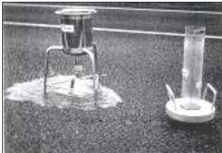
Figura V-2. Permeámetro LCS (derecha) y permeámetro Zarauz (izquierda).
