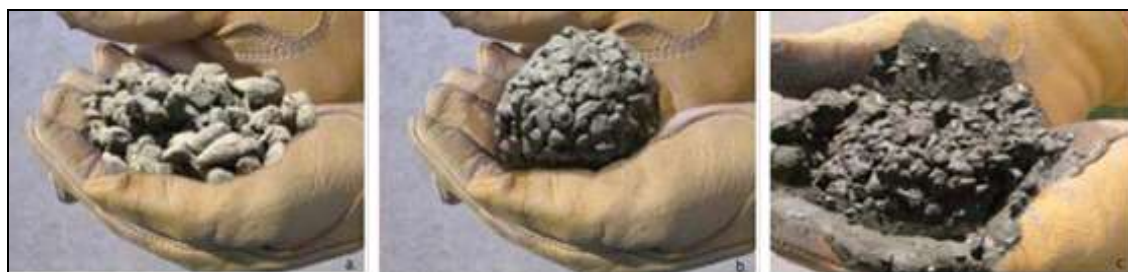
Figura III-1. Muestras de hormigón poroso con diferentes contenidos de agua. (a) poca cantidad de agua, (b) cantidad apropiada de agua (c) demasiada cantidad de agua. (Fuente: EPA, 1999)
