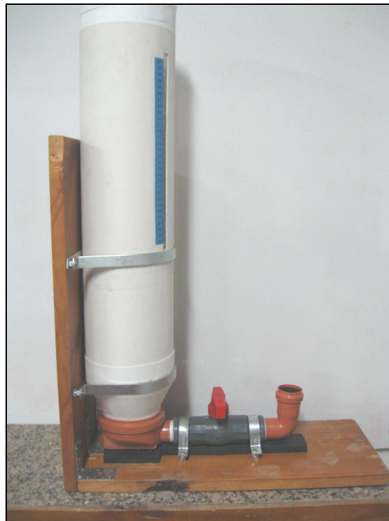
Figura IV-13. Equipo para medir permeabilidad
