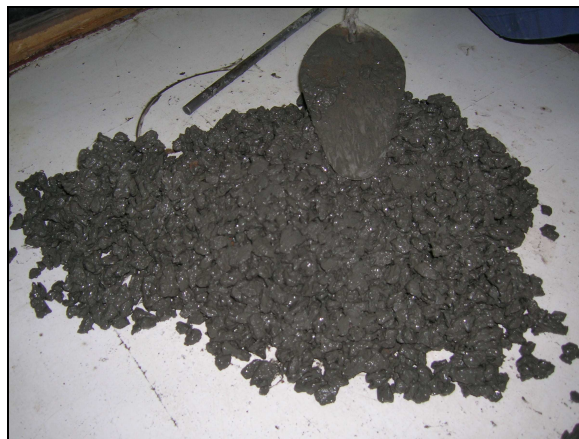
Figura IV-8. Evaluación de posible segregación de pasta en la serie K
