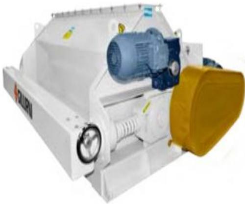
Los quebradores de pellet poseen dos rolos rayados con sistema de ajuste de separación de rolos manual y sistema de seguridad (separación de rolos mecánico) para evitar rotura por objetos extraños. El alimentador rotativo accionado mediante reductor regula la carga de producto y válvula de by-pass para evitar el paso de los pellets a través del quebrantador en caso de ser necesario.
