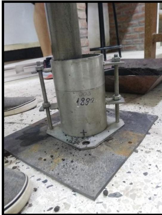
Figura 4-19 - Acción del pisón sobre una muestra
