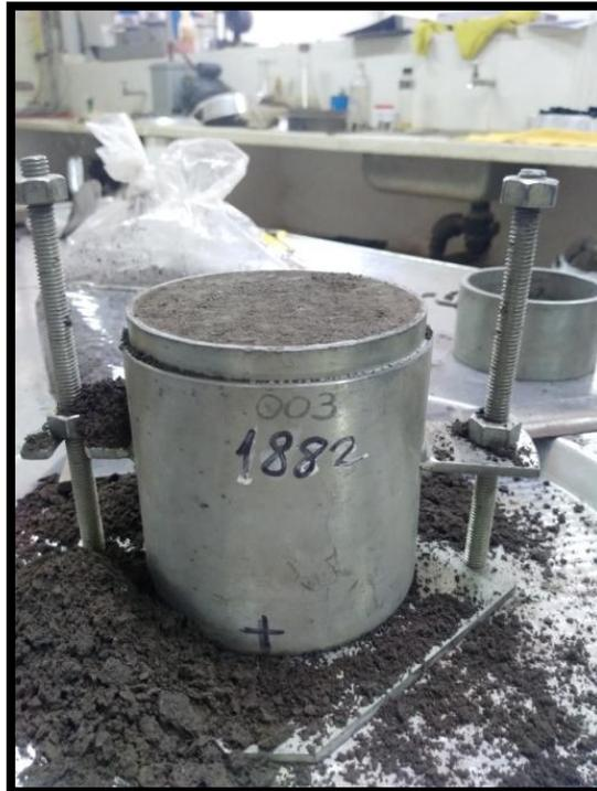
Figura 4-21 - Enrasado de muestra en molde
