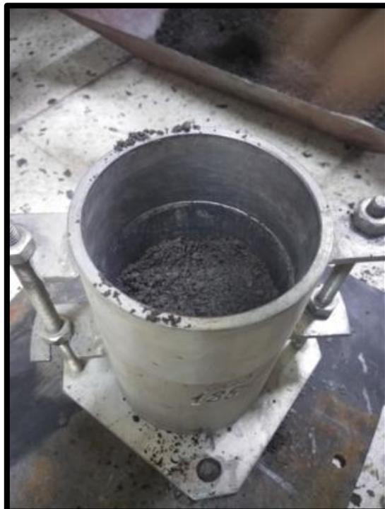
Figura 4-18 - Vertido de muestra en molde
