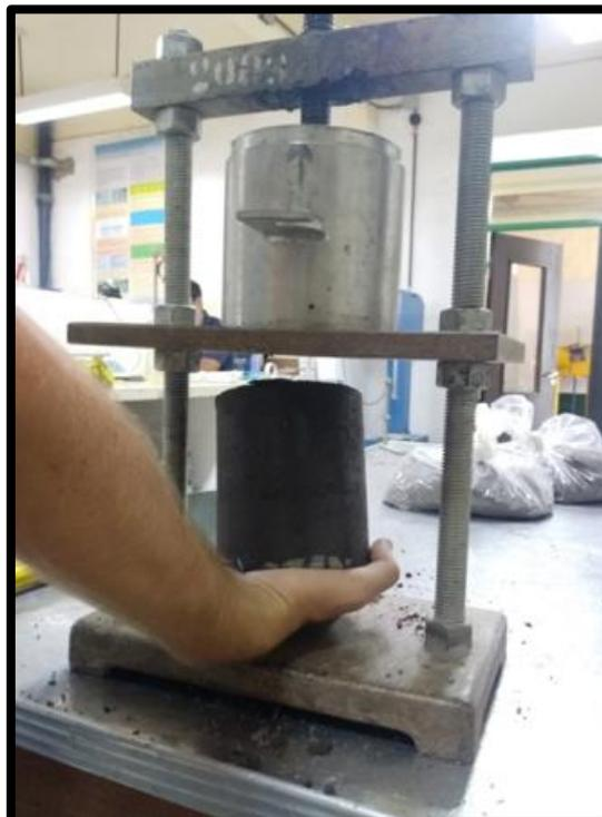
Figura 4-22 - Separación de muestra y molde
