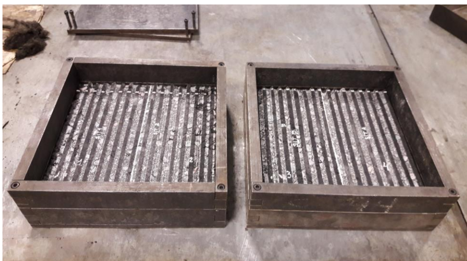
Figura 6-63. Bases para las probetas con fresado simulado para el Caso 4 Fuente: elaboración propia
