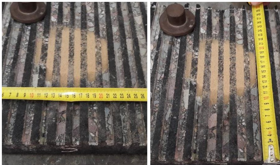
Figura 4-47. Parche de Arena, probeta Caso 5 Fuente: elaboración propia
