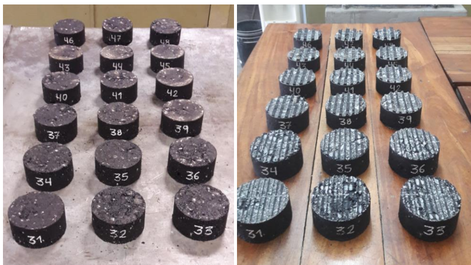
Figura 6-24. Bases de las probetas antes y después del fresado, Situación 2 Fuente: elaboración propia
