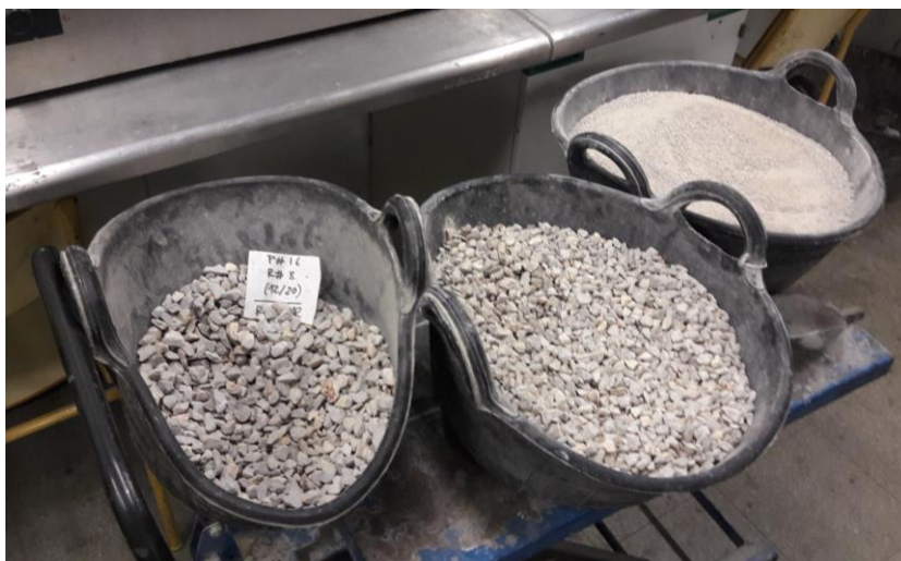
Figura 7-21. Agregados calizos utilizados en la experiencia Fuente: elaboración propia
