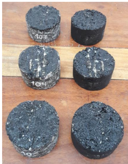
Figura 7-18. Probetas ensayadas de la Dotación I a III Fuente: elaboración propia
