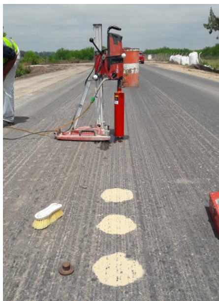
Figura 7-6. Determinaciones análogas al Ensayo de Parche de Arena efectuadas Fuente: elaboración propia
