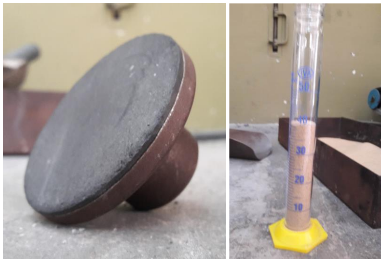
Figura 4-42. Detalle pisón normalizado (izq.) y vol. de ensayo (der.) Fuente: elaboración propia
