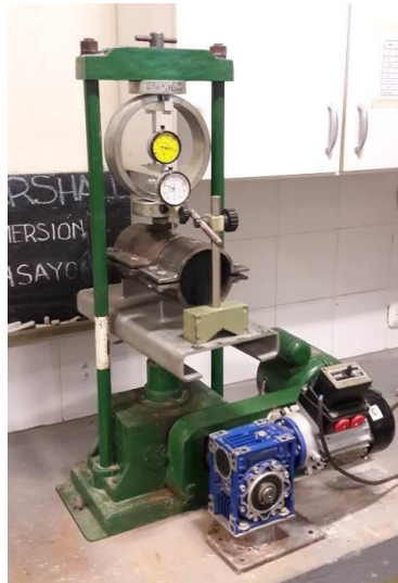
Figura 5-26. Realización del Ensayo de LCB Fuente: elaboración propia
