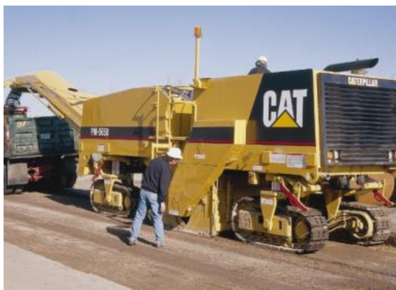
Figura 4-11. Tipo de equipo de fresado empleado en la Obra B en estudio Fuente: www.specsandbrochures.com
