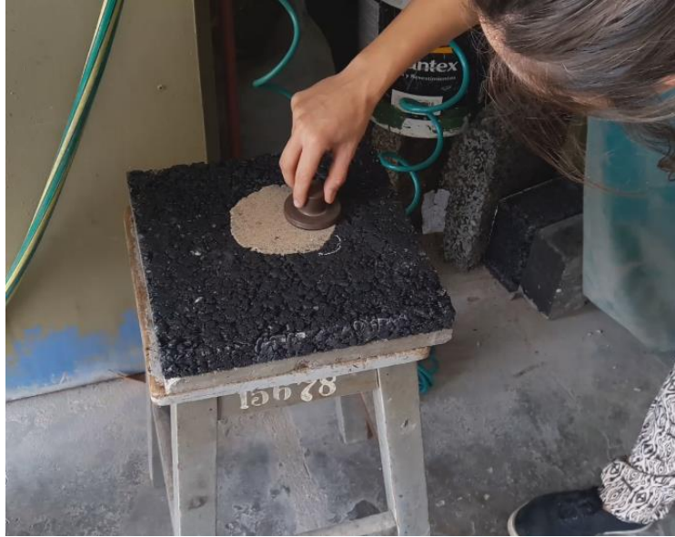
Figura 4-6. Realización de un Ensayo de Parche de Arena en laboratorio Fuente: elaboración propia
