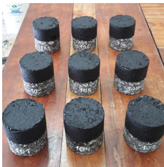
Figura 7-14. Probetas dobles moldeadas a partir de los testigos extraídos Fuente: elaboración propia
