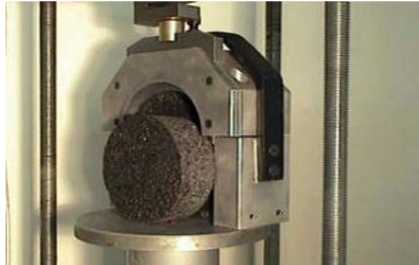
Figura B-3. Ensayo de corte sobre testigos Fuente: Montetrusque et al., 2015
