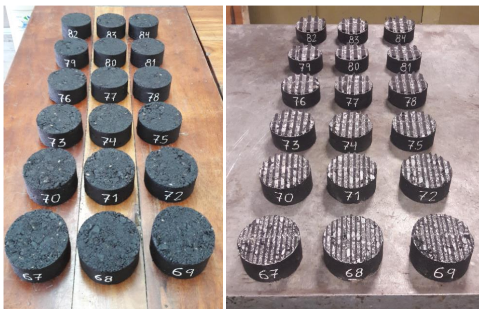
Figura 6-42. Bases de las probetas antes y después del fresado, Situación 4 Fuente: elaboración propia
