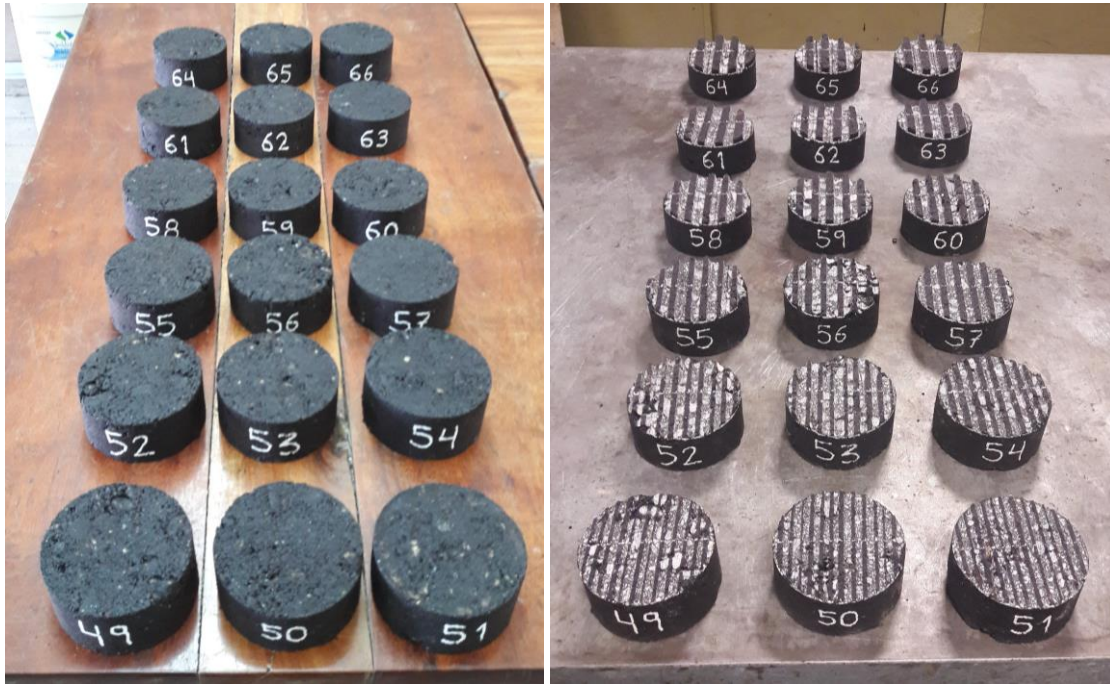
Figura 6-33. Bases de las probetas antes y después del fresado, Situación 3 Fuente: elaboración propia
