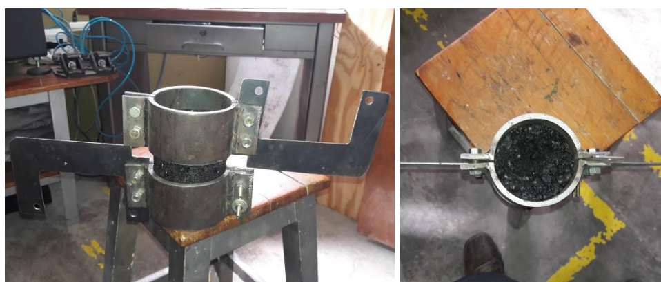
Figura 5-9. Imágenes en vista y planta de una probeta doble con mordazas Fuente: elaboración propia
