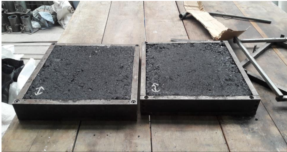
Figura 6-62. Bases para las probetas moldeadas con Roller Compact Fuente: elaboración propia
