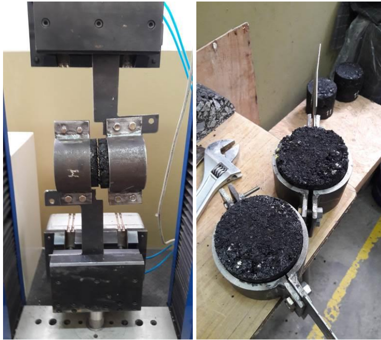
Figura 5-12. Vistas de la rotura en la interfase de una probeta doble Fuente: elaboración propia
