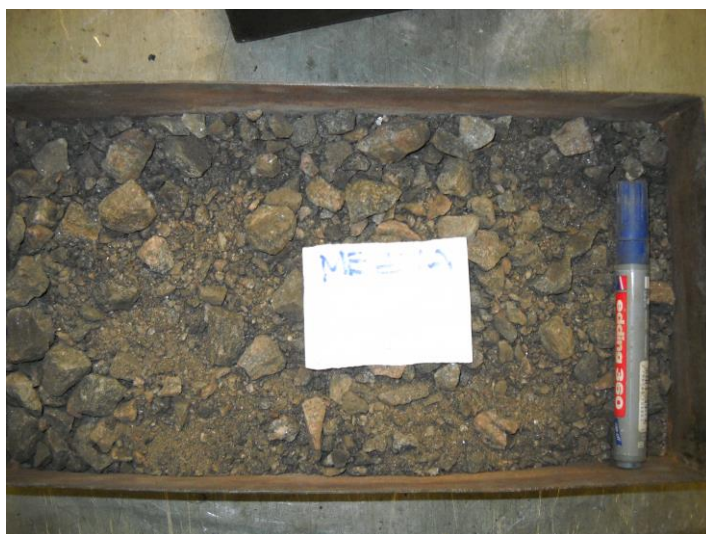
Figura 7-12. Áridos recuperados de la mezcla asfáltica de los testigos Fuente: elaboración propia
