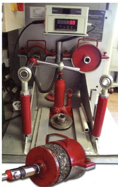
Figura B-4. Ensayo de torsión sobre testigos Fuente: Nynas, 2007
