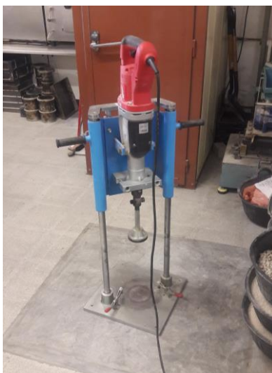
Figura 7-22. Equipo para la compactación de laboratorio Fuente: elaboración propia
