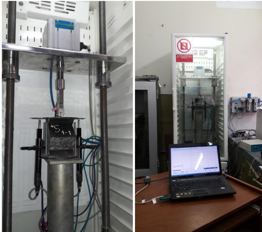
Figura 6-68. Imágenes durante el ensayo a fatiga de una de las probetas cúbicas Fuente: elaboración propia
