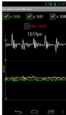
Figura 2 Registro de aceleraciones con el acelerómetro en un celular.
