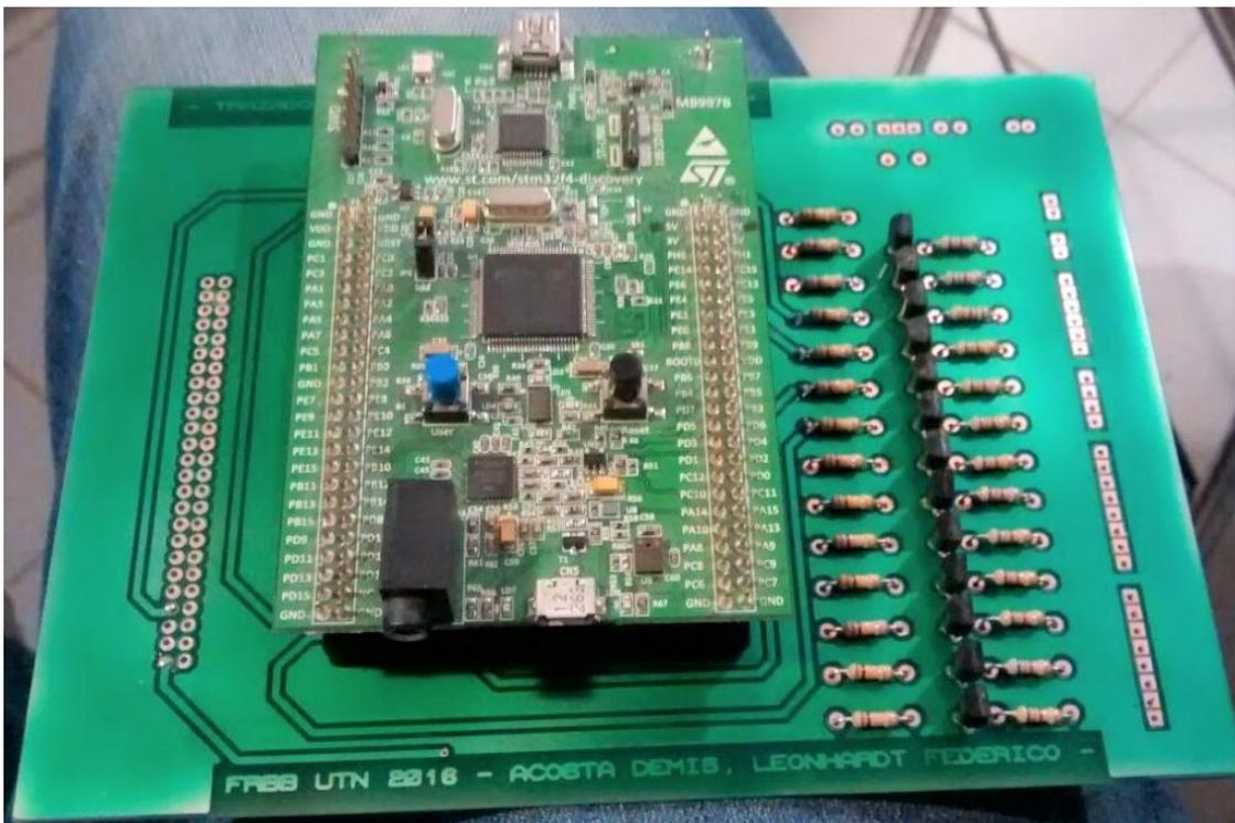
Figura 15: Montaje de Kit STM32F4 en placa electrónica de control
