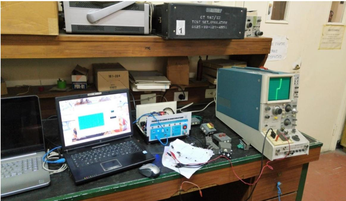
*Figura 63: Ensayo de diodo con equipo Trazador*
