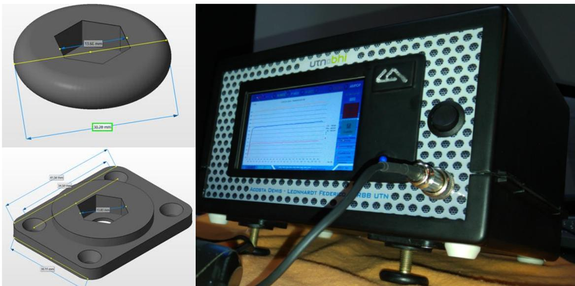
Figura 62: Soporte de apoyo para gabinete de Trazador
