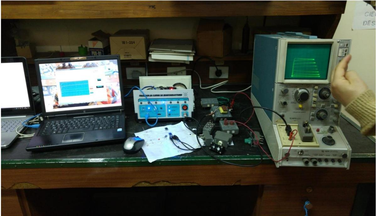
Figura 64: Ensayo de transistor con equipo Trazador
