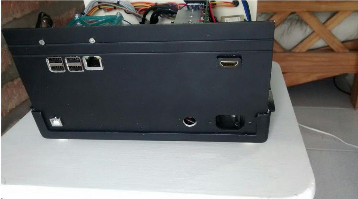
Figura 61: Calado para periféricos de Trazador
