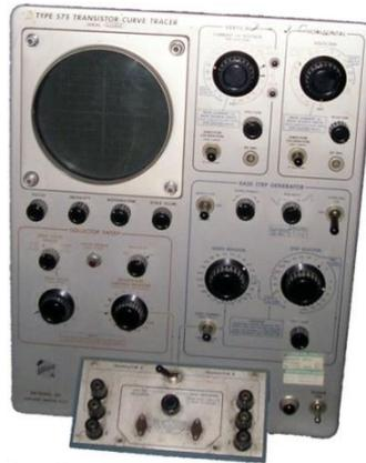
*Figura 7: Trazador Tektronix 570*
