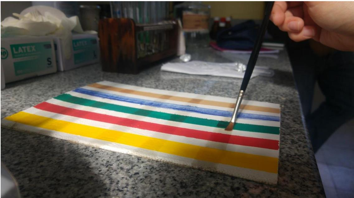
Los ensayos que se les realizarán a las resinas preparadas son: espectroscopia UV, IR, rugosidad, color, pureza, envejecimiento. Este último sirve para evaluar que sucede con la resina con el pasar del tiempo.
