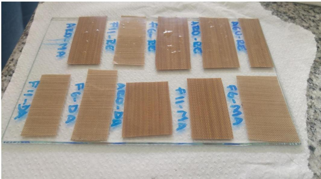
Se prepararon probetas de tela (lino + CaCO<sub>3</sub> + pigmento (con cola de conejo)), para simular lo que ocurriría en una obra de arte real. Luego se realizaron dos ensayos, para caracterizarlo "in situ" (en probetas), llevándolo a una cámara con T y humedad adecuados.
