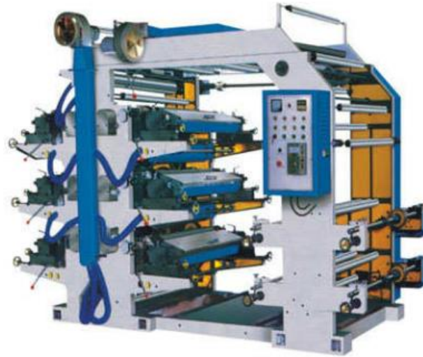
Impresora Flexográfica con capacidad de imprimir varios colores en una sola pasada del rodillo
