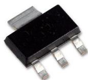
Observando su hoja de datos encontramos que ofrece cinco salidas de tensiones: 1.8 – 2.5 – 3.3 – y 5 V. Siendo la configuración de 3.3 V la que se utiliza para alimentar el módulo ESP8266 de nuestro servidor. Estos rangos de tensiones los ofrece con una entrada de hasta 20 V.
