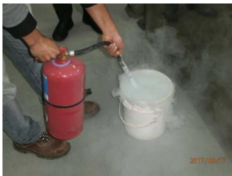
Figura 7: Saturación de la cámara con el vaciado del matafuego
