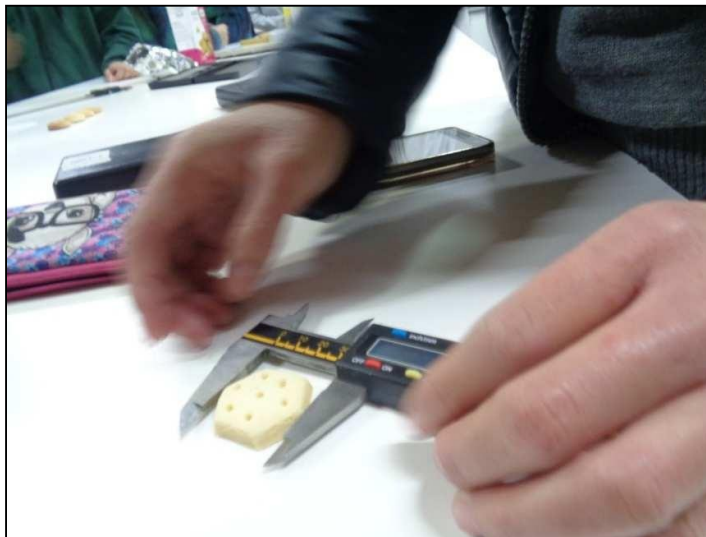
Figura 3. Medición del Diámetro (mm) y Espesor (mm), con calibre Digital.
