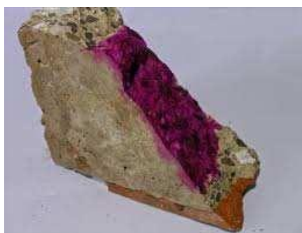
Figura 8: Probetas fracturadas en las cuales se evaluó el nivel de carbonatación con fenolftaleína..
