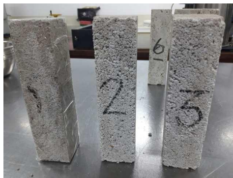
Figura 6: Probetas "porosas", siendo la N°1 aislada mediante un recubrimiento de cinta adhesiva.
