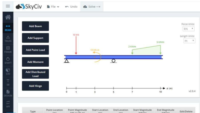
figura 2. Ilustración de la captura de pantalla del software skyciv en donde se puede apreciar un sistema de una chapa isostática, constituida por un apoyo simple y uno doble y un estado de cargar conformado por una carga puntual, una distribuida y un momento concentrado.
