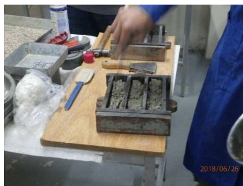
Figura 4: Llenado de moldes para confección de las probetas de 4 x 4 x 16 cm.
