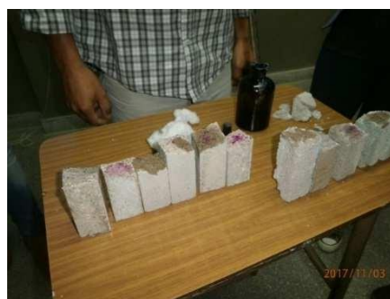
Figura 8: Probetas fracturadas en las cuales se evaluó el nivel de carbonatación con fenolftaleína..
