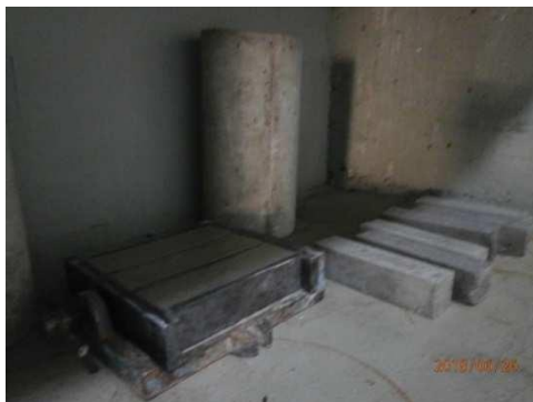
Figura 5: Probetas en la cámara de curado.
