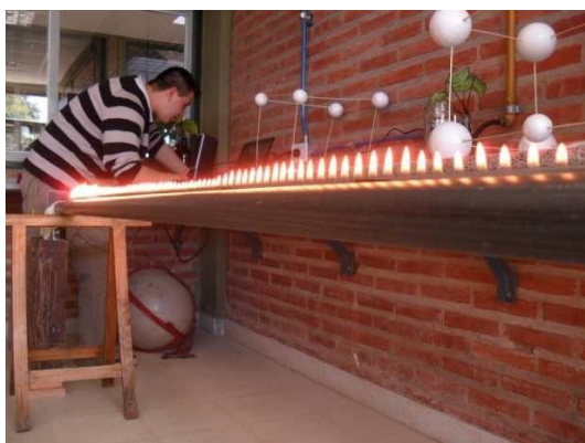
Foto N°1: Disposición del tubo en forma totalmente horizontal con la ayuda de un caballete replegable.
