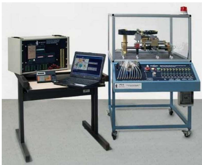
Foto 1: Robot neumático a 5 ejes + autómatas programables (PLC)
