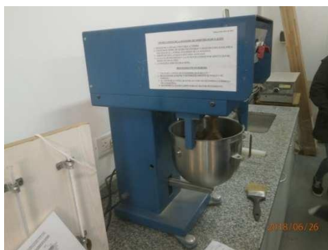
Figura 3: Máquina mezcladora normalizada.
