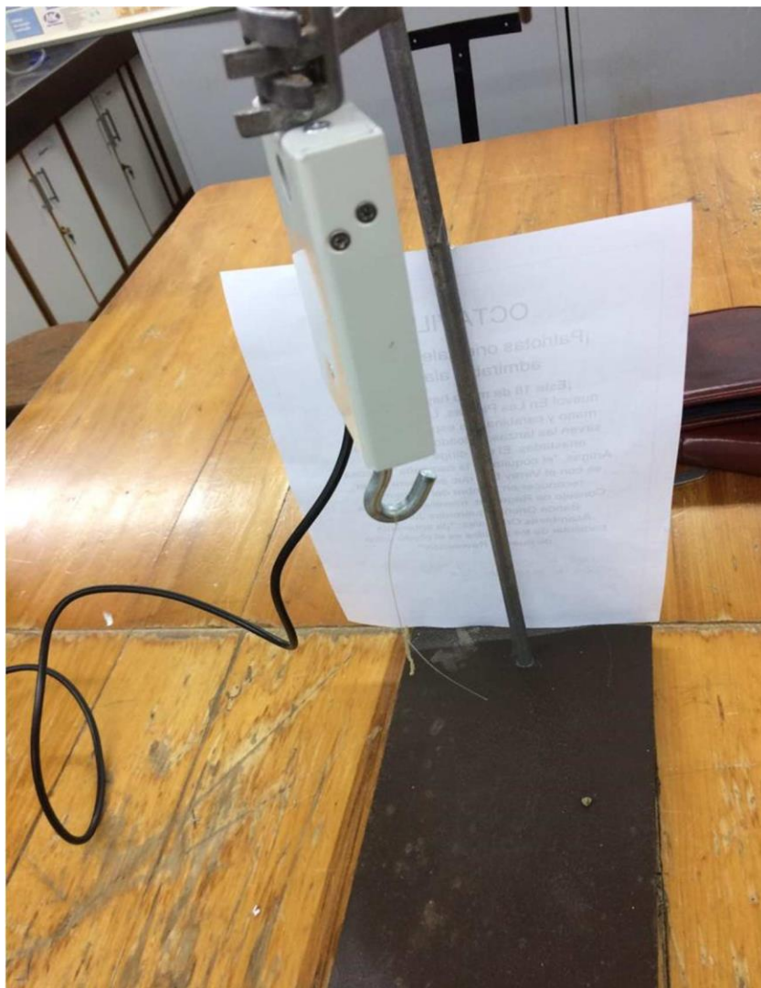
Figura 3. Determinación de la resistencia de hebras de caucho.
