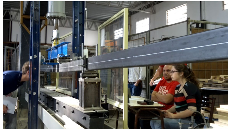
Fig. 13 – Etapa final ensayo viga hiperestática (equipos de ensayo provistos por grupo de investigación de madera)
