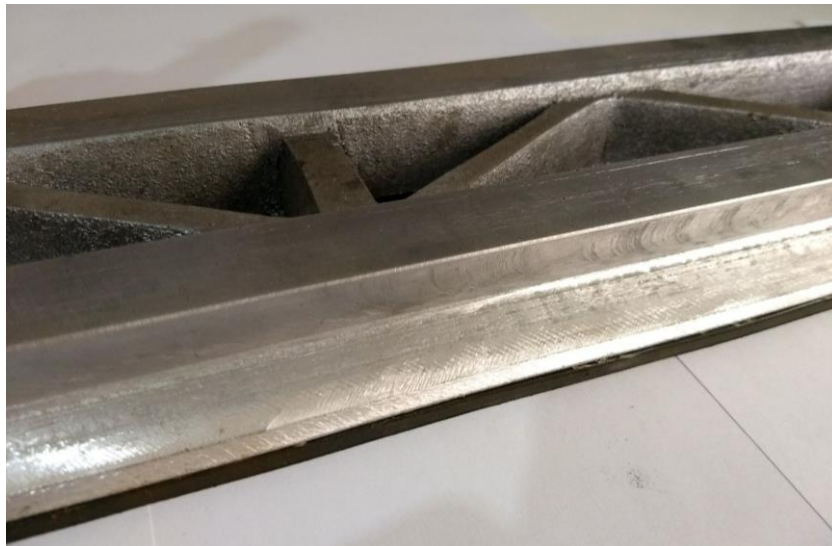
Figura 30 – bancada aluminio mecanizada (vista lateral)
