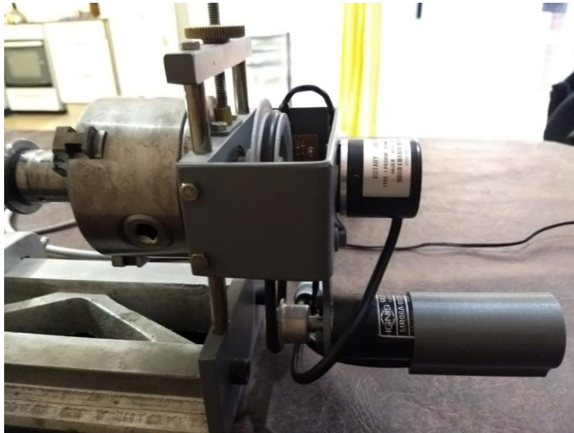
Figura 40 – montaje dispositivo (vista posterior sistema de tracción)
