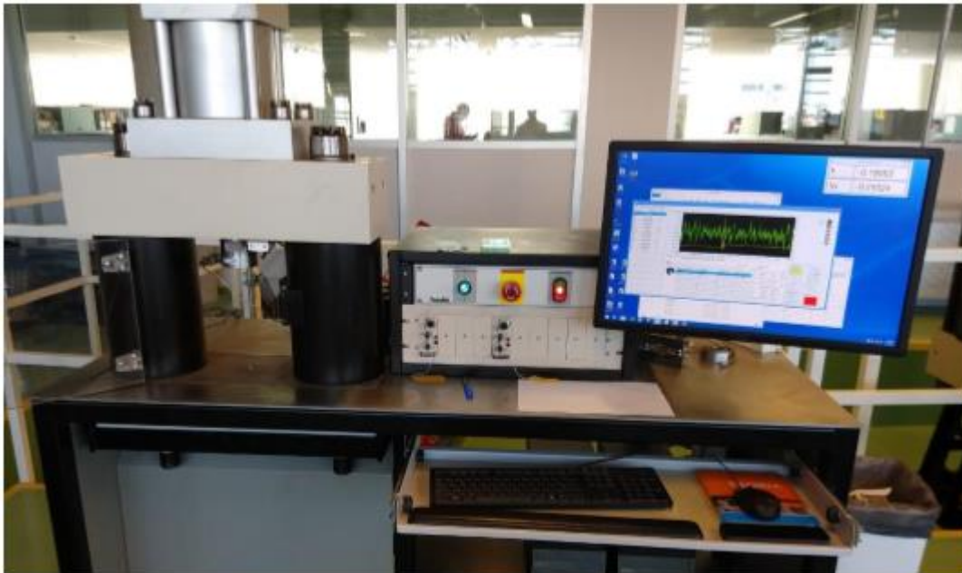
Fig. 4: Máquina uniaxial de ensayos, ubicada en Y-Tec
