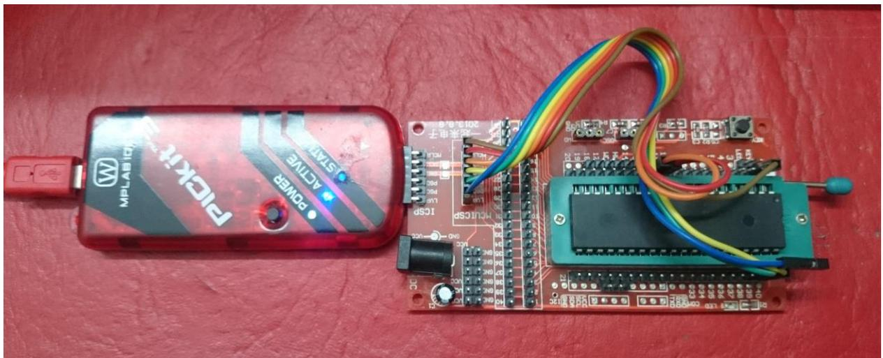
Fig. N° 6 "PICkit3 y PIC18F4550 En Proceso De Grabado"
