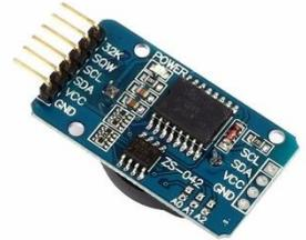
Figura 5.8.4: Módulo RTC
