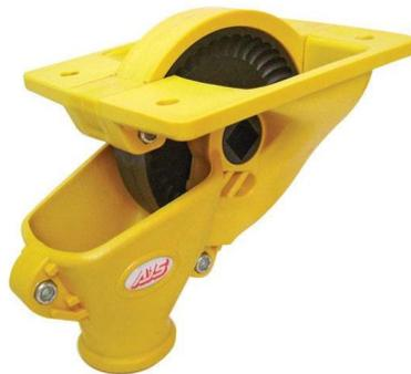
Figura 5.2.2: Sistema de siembra tipo platillo vertical
