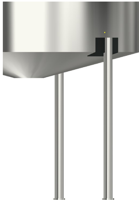
Imagen 42 - Pata con poncho soldado al recipiente
