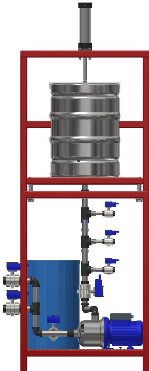
Imagen 13 - Llenadora y lavadora de cerveza vista frontal
