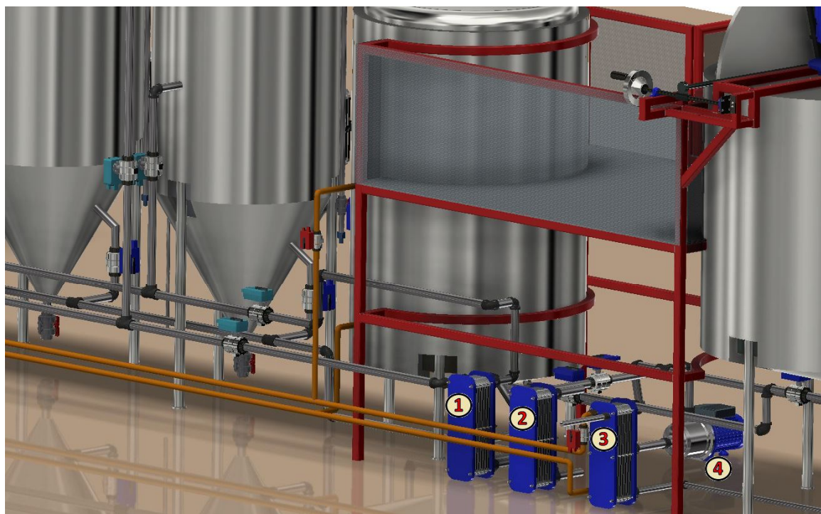
1,2,3) Intercambiadores de placas 4) Bomba
