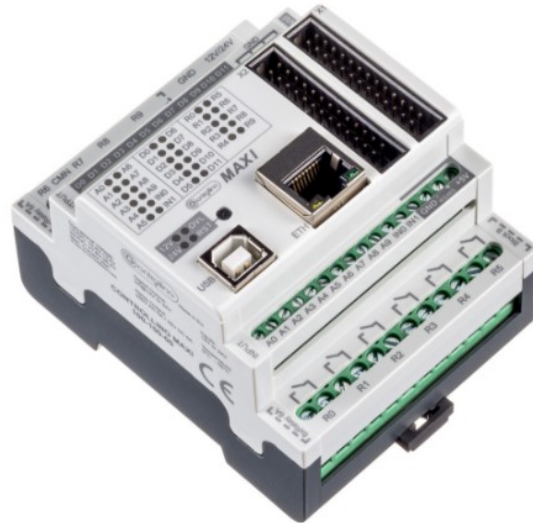
Imagen 14 - Foto ilustrativa PLC Controllino
