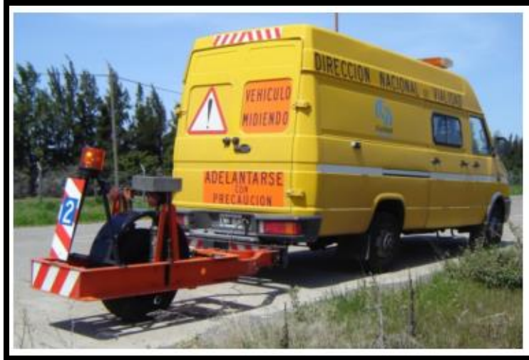
Foto 9: Rugosímetro BPR, tipo respuesta dinámica. La rueda de medición copia las irregularidades superficiales, valorando el confort de circulación
