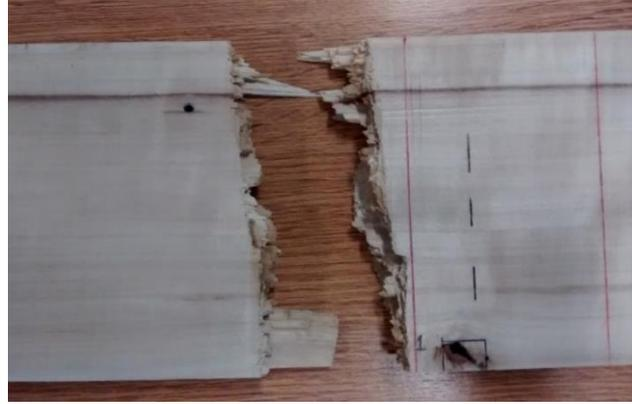
*Figuras 49 y 50 – Ejemplo de rotura normal*
