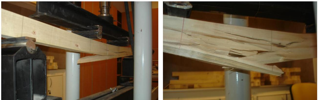
*Figuras 45 y 46 – Ejemplos de rotura normal*
