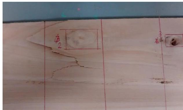
*Figura 52 – Ejemplo de rotura por nudosidad*
