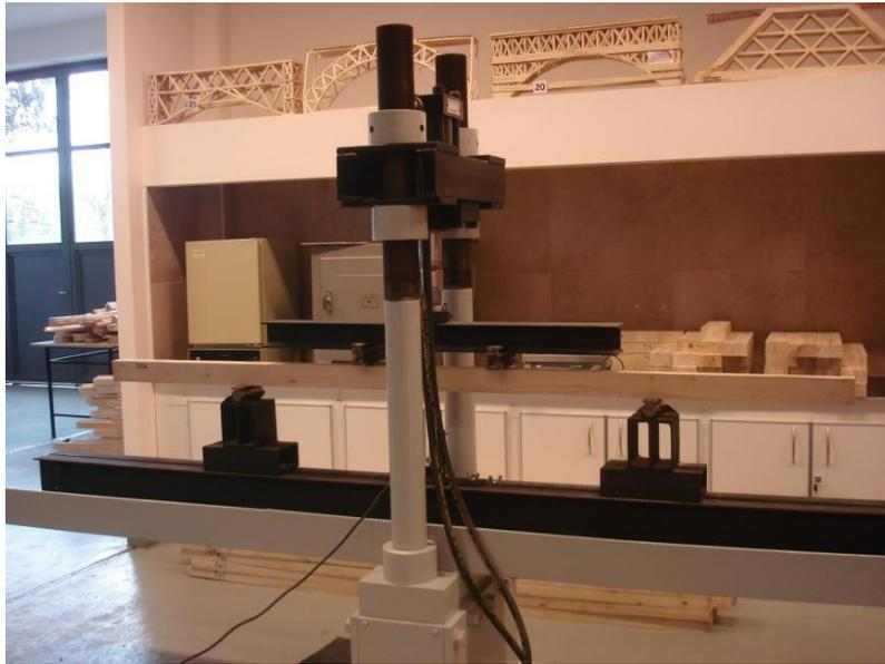
*Figura 42 – Colocación del espécimen en la prensa*
