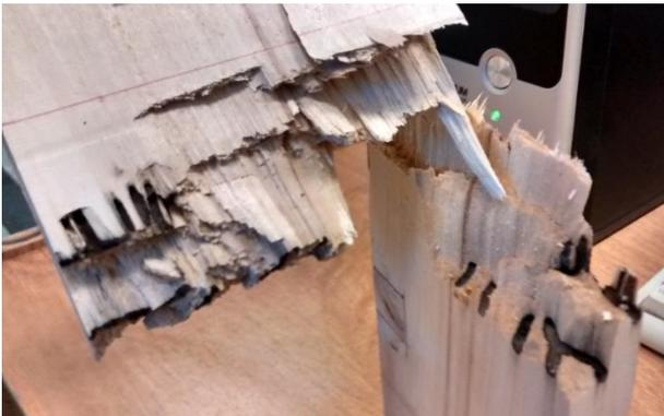
*Figura 51 – Ejemplo de rotura por taladrillo*
