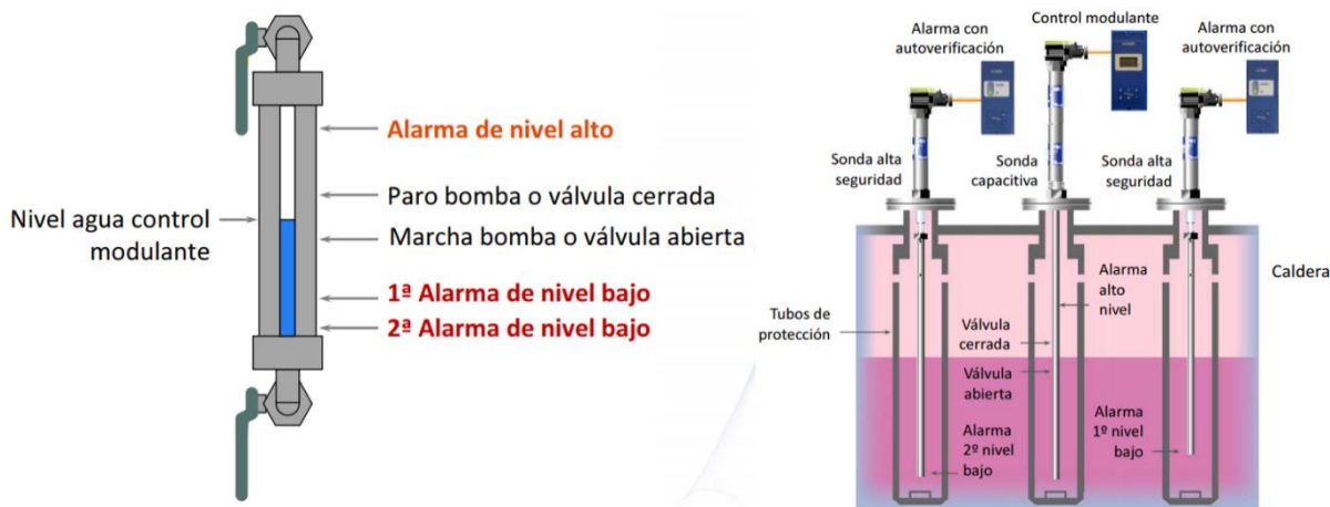
Figura 14.88: Control de nivel en la caldera. Fuente: www.fenercom.com . Última revisión: abril 1, 2018.
