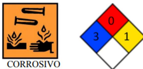
Figura 8.60: Señalización para los tanques de HS (a) Identificación NFPA (b) Identificación NU
