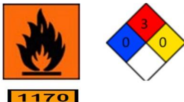
Figura 8.58: Señalización para los tanques de almacenamiento de AE (a) Identificación NFPA (b) Identificación UN
