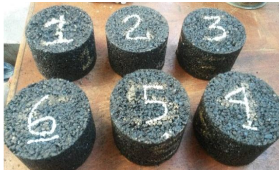
Figura 7: Probetas antes de ensayar a 25 °C a cohesión.
