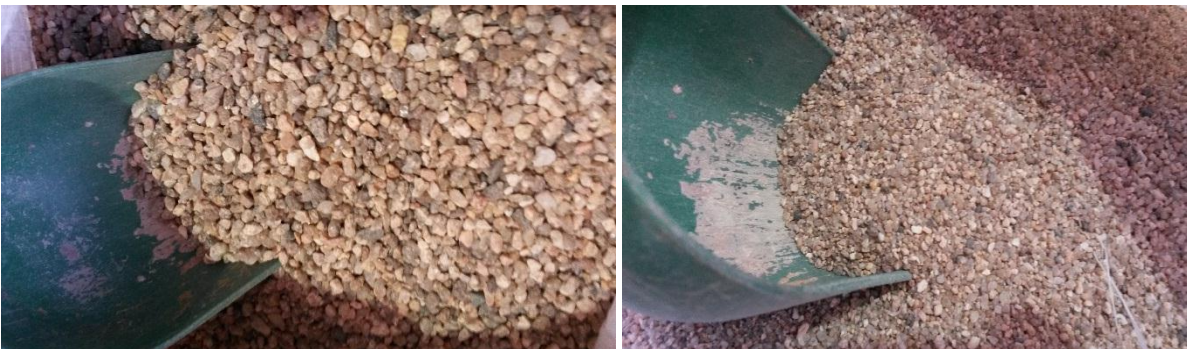
Figura 5: Agregado arena natural. Izq.: Fracción Retenido Tamiz Nº 8. Der.: Fracción Retenido Nº 30.
