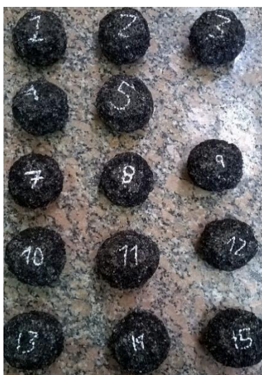
Figura 12: Probetas después de ensayadas (-10 °C) para susceptibilidad térmica.
