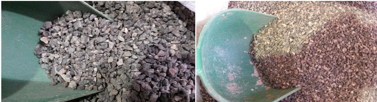
Figura 3: Agregado arena trituración 0-6 mm. Izq.: Fracción Retenido Tamiz Nº 8. Der.: Fracción Retenido Nº 30.
