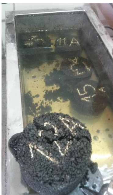
Figura 11: Probetas durante el acondicionamiento para adherencia durante 24 hs en agua a 60 °C.
