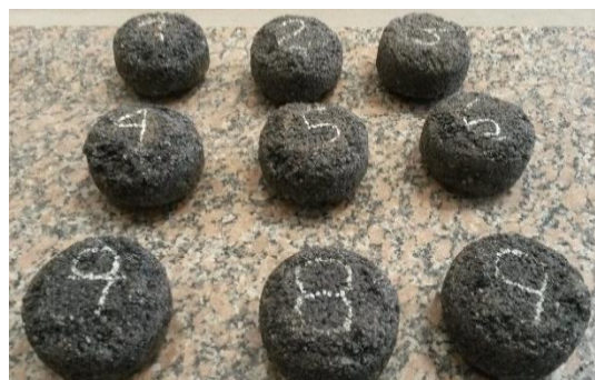
Figura 8: Probetas después de ensayar a 25 °C a cohesión.
