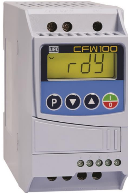
Ilustración 34. Variador de frecuencia CFW100 (Weg CFW100 Manual de usuario, 2013).
