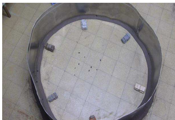
Figura 9. Arena de experimentación: cilindro de chapa galvanizada de 1,57 m de diámetro y 0,4 m de alto con la base sellada con barro
