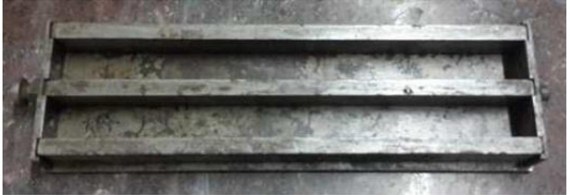
**Figura 3.14.** Molde para mortero de 30 x 30 x 220 mm<sup>3</sup>.
