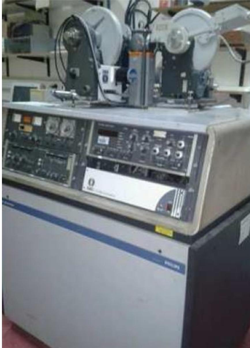
**Figura 3.4.** Difractómetro de rayos X Phillips 3020
