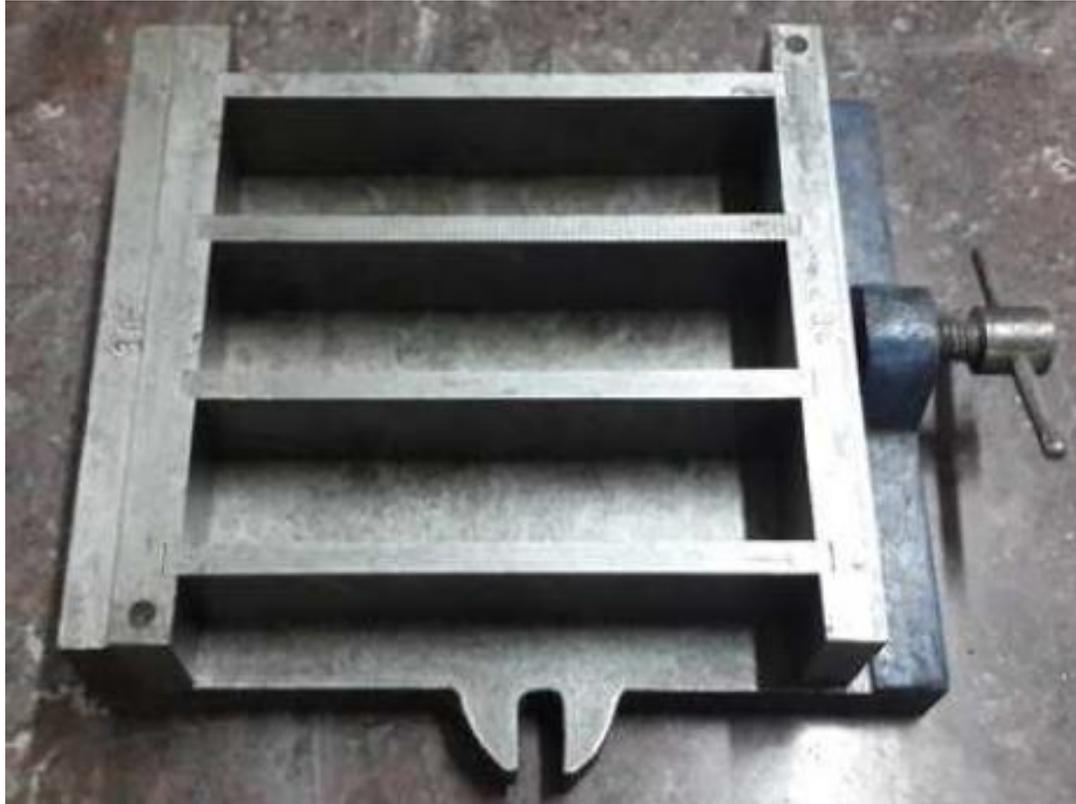
**Figura 3.13** Molde para morteros de 40 x 40 x 160 mm<sup>3</sup> de tamaño.
