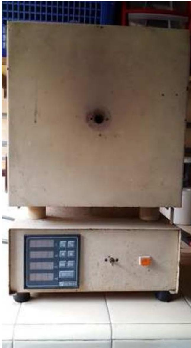
**Figura 3.2.** Mufla calefactora Marca Estigia, Modelo D1.
