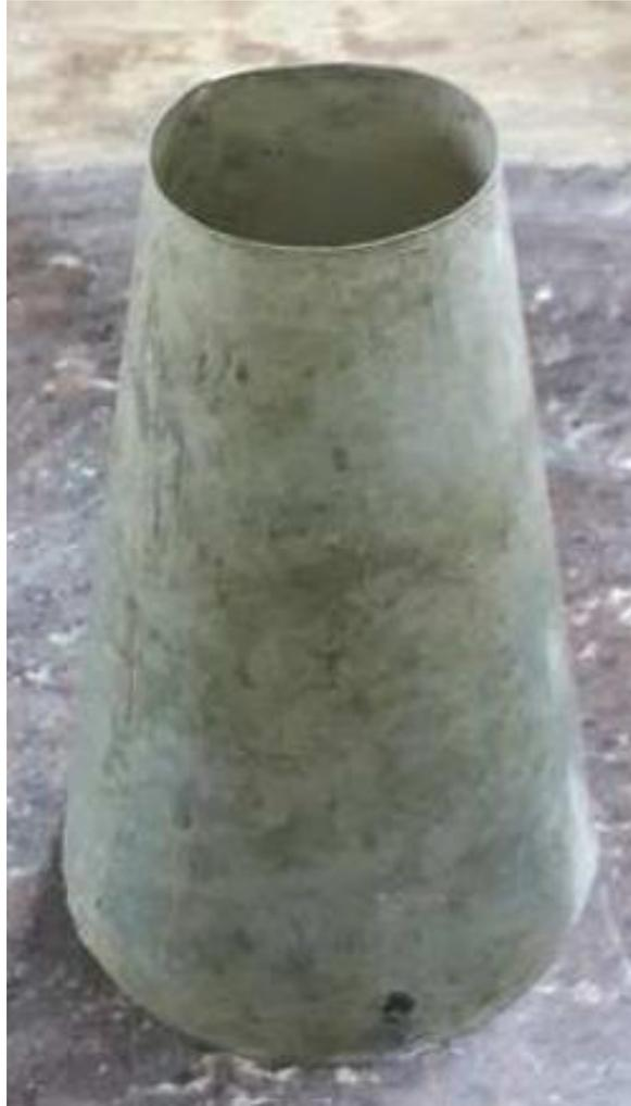
**Figura 3.12** Cono metálico de 150 mm de altura.
