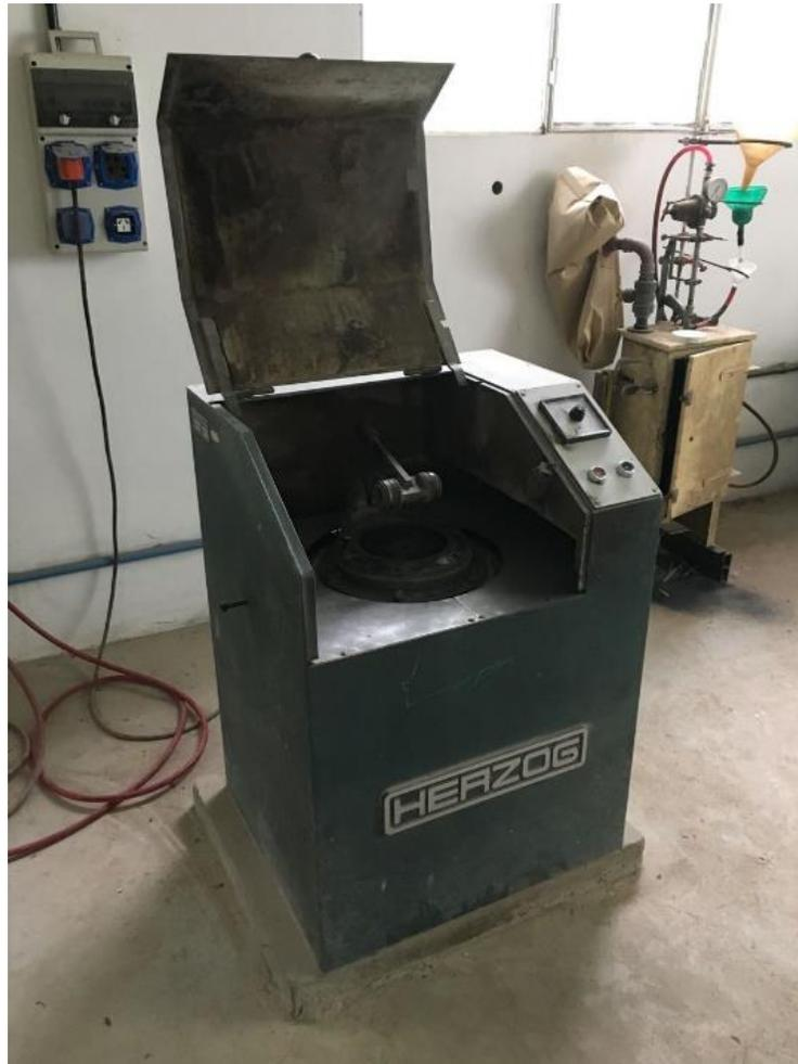
**Figura 3.1** Molino oscilante tipo Herzog HSM 100
