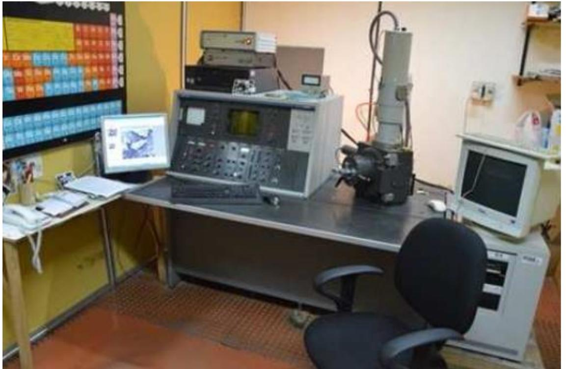
**Figura 3.6.** Microscopio electrónico de barrido Phillips 505.
