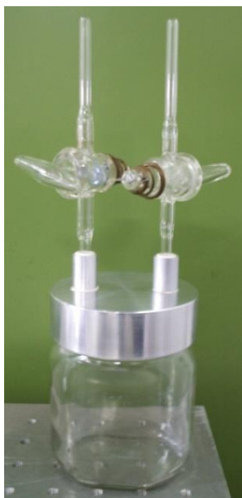
Figura 4.9. Fotografía del recipiente utilizado para tomar muestras de gases emanados por tomates.
