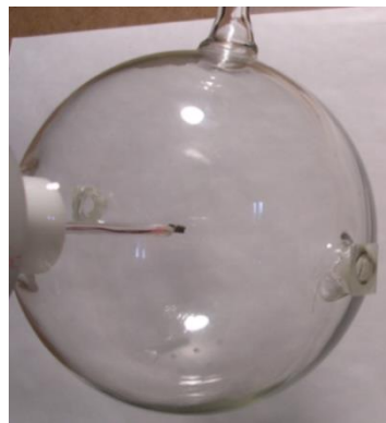
Figura 5.5. Celda esférica de Pyrex, R = 50 mm, f_0 = 4920 HZ
