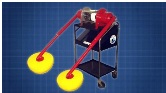
Foto N° 4: Dispositivo a instalar en la escollera. Modelo 1:10. Fuente: Grupo Undimotriz
