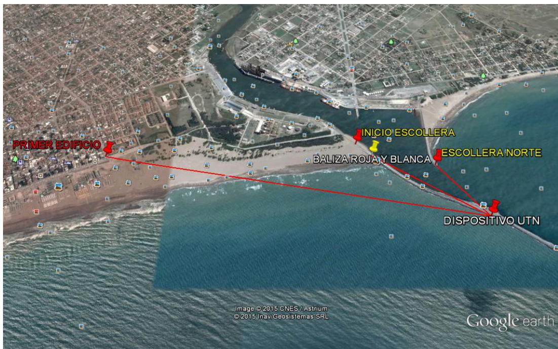
Foto N° 15: Ubicación del dispositivo y distancias. Dispositivo UTN a Escollera Norte: 510m, a Baliza Roja/Blanca: 890m, al Primer edificio: 2700m. Fuente: Google Earth
