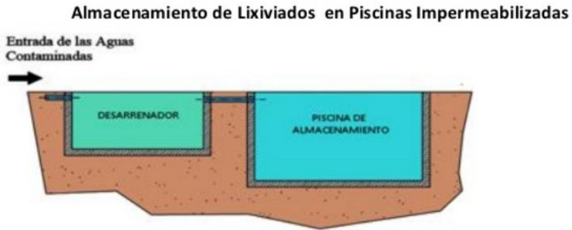
Figura- Almacenamiento de lixiviados en piletas de contención
