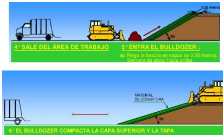
Figura- Descarga, colocación, compactación y cubierta de residuos sólidos
