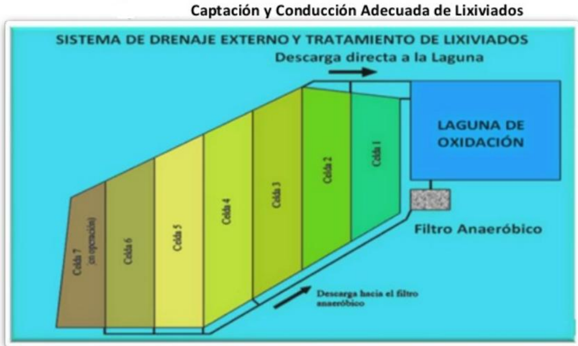
Figura.2- Sistema interno de captación y conducción de lixiviados
