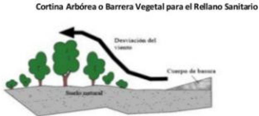
Figura 1. Esquema de una cortina forestal
