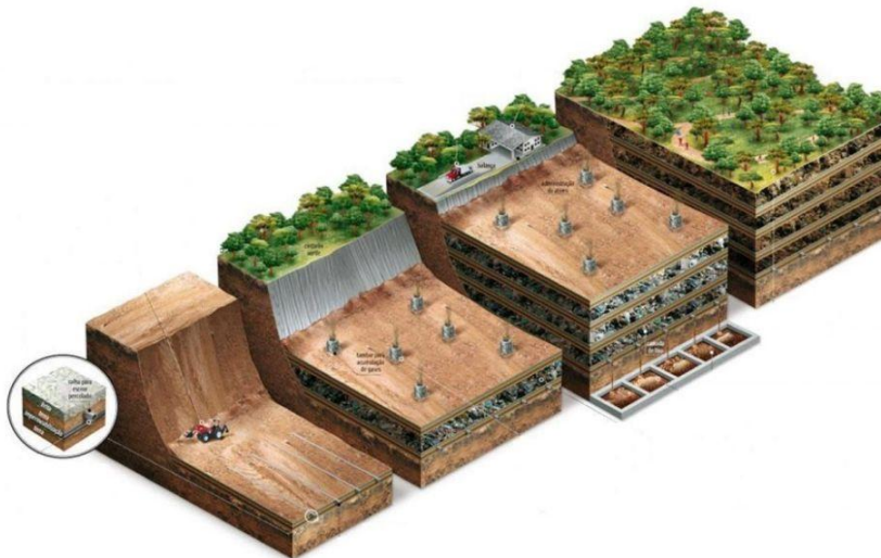
Figura 2. Esquema de una barrera vegetal durante todo el proceso del Relleno
