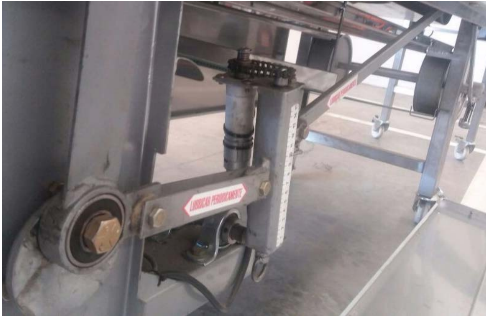
Fig. 9 – Motor de CD para graduación de velocidad de cinta de corte
