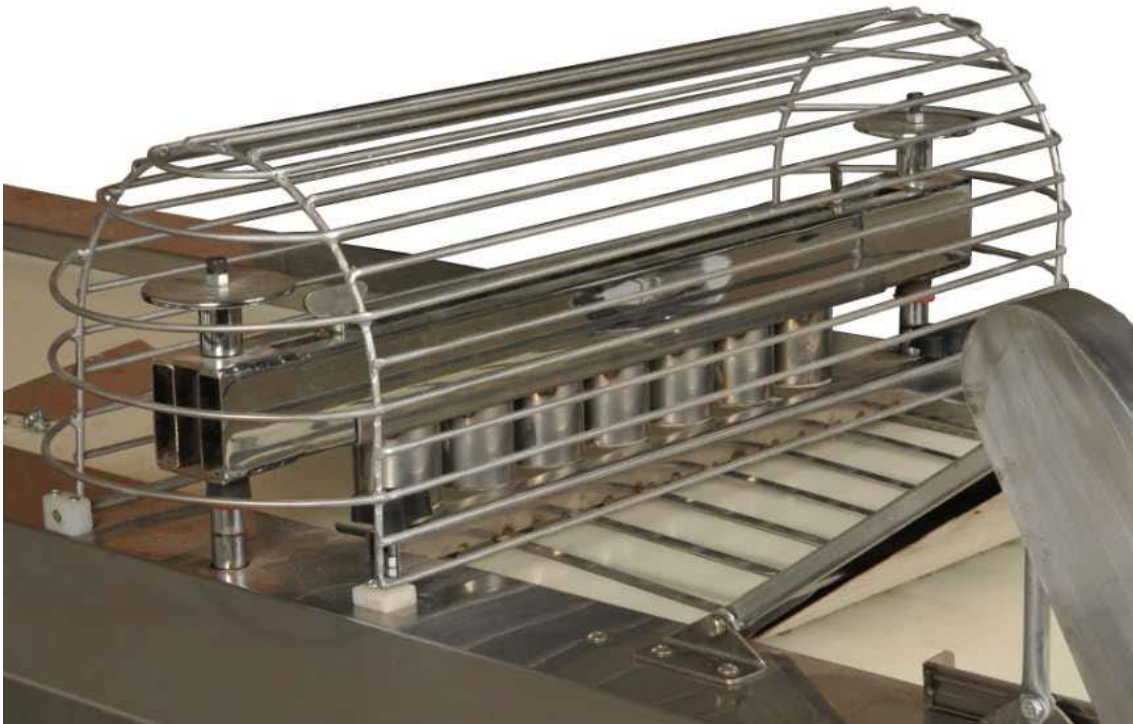
Fig. 11 – Rejilla de seguridad y soporte para moldes
