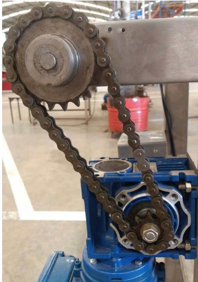
Fig. 8 – Motorreductor adosado a motor y engranajes con cadena de transmisión
