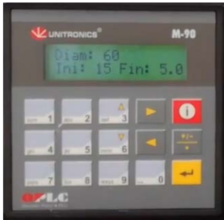
Fig. 27 – Pantalla de calibración de moldes y espesores de masa
