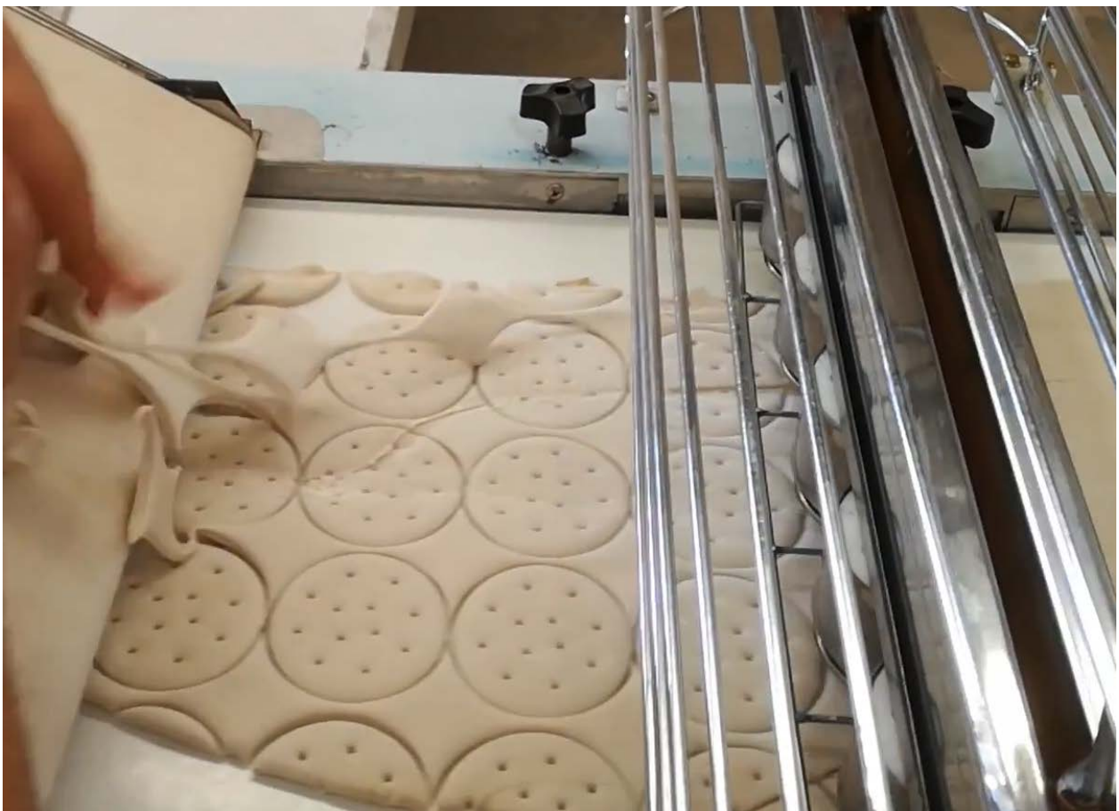
Fig. 30 – Imagen de masa cortada por moldes de 80 mm
