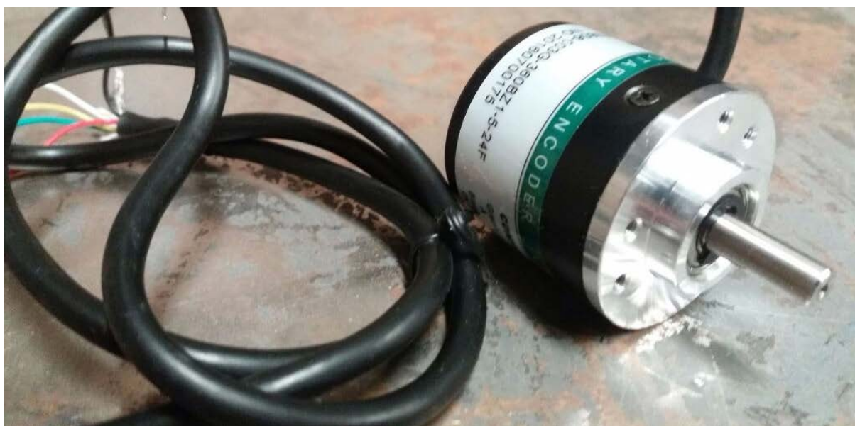
Fig. 10 – Encoder utilizado en cinta de corte
