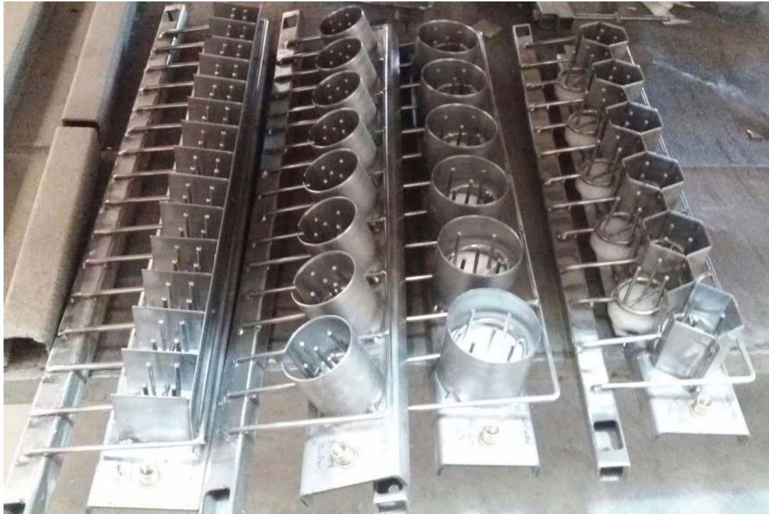
Fig. 12 – Moldes de corte y sus diversas formas
