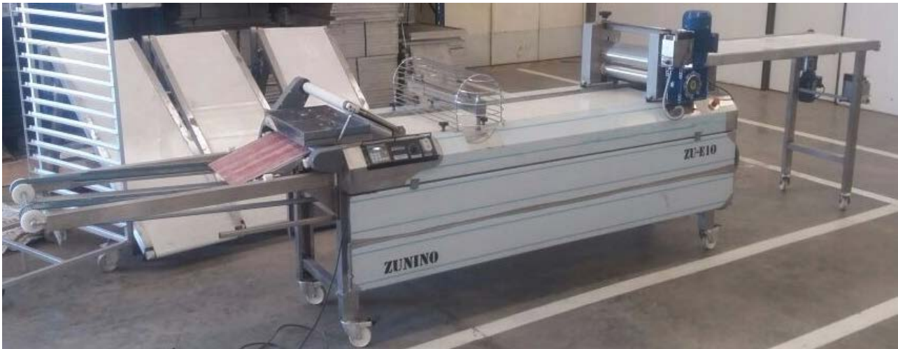
Fig. 25 – Foto de laminadora con automatización incorporada
