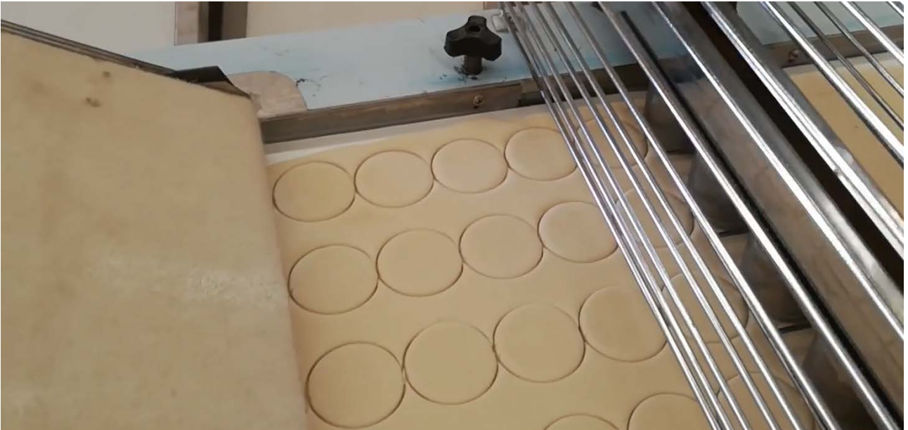
Fig. 29 – Imagen de masa cortada por moldes de 60 mm
