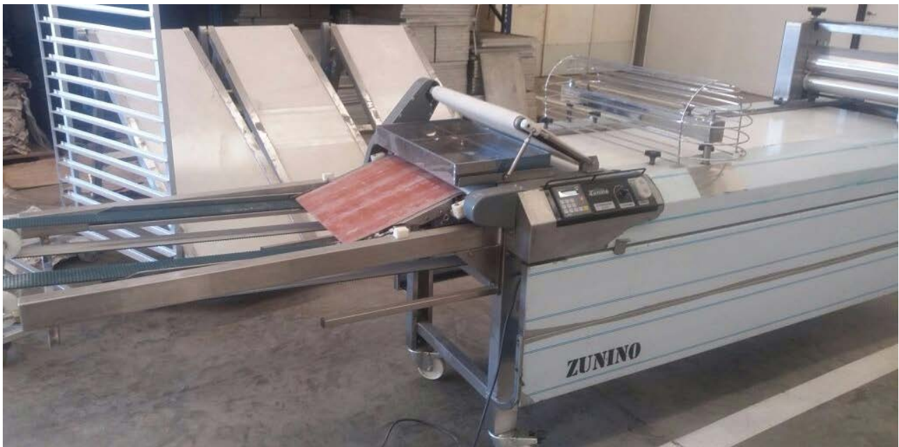
Fig. 3 – Cinta de Corte y Transportador de Bandejas
