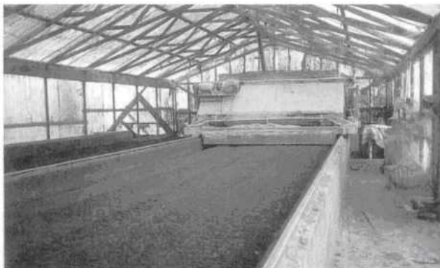
Figura 4. Sistema de compostaje de lecho horizontal agitado con una cama simple
