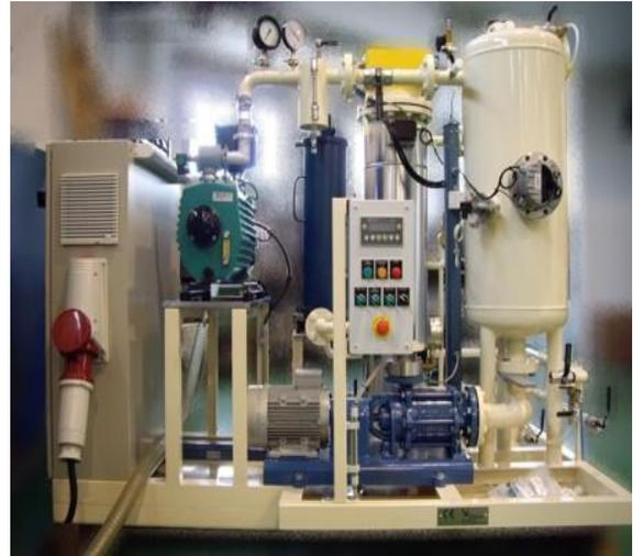
El equipo de tratamiento de aceite de transformadores de gran porte, con características constructivas antiexplosivas, si fuere necesario, procesa hasta 9000 litros por hora con vacío y calor, para obtener un contenido de agua final de menos de 3 ppm y aceite libre de partículas de hasta 1 $\mu$ m (con opción de 0,5 $\mu$ m)
