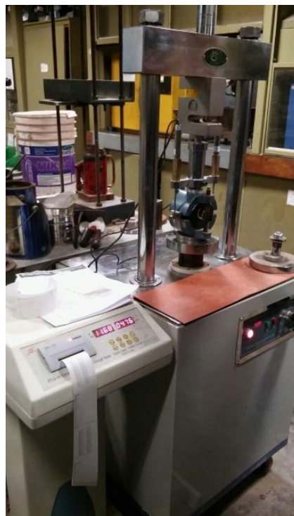
Figura 3. Equipo de ensayo Marshall automatizado del LEMaC Fuente: elaboración propia
