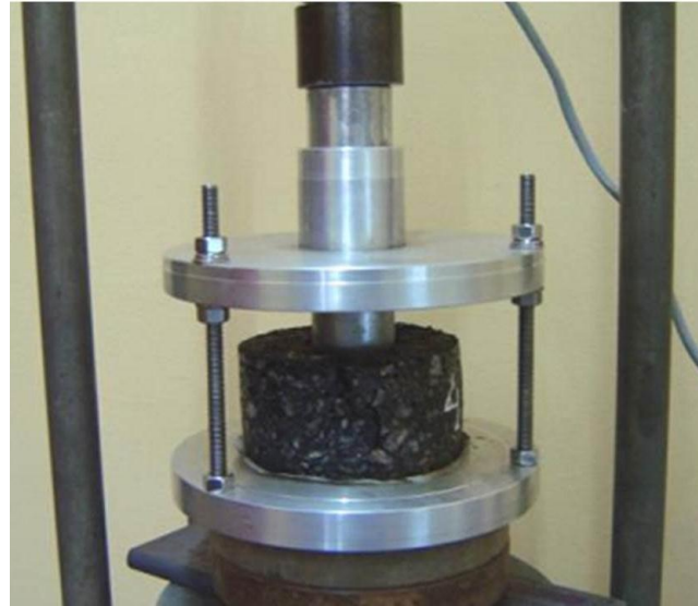
Figura 2. Ensayo de punzonado en el LEMaC Fuente: elaboración propia
