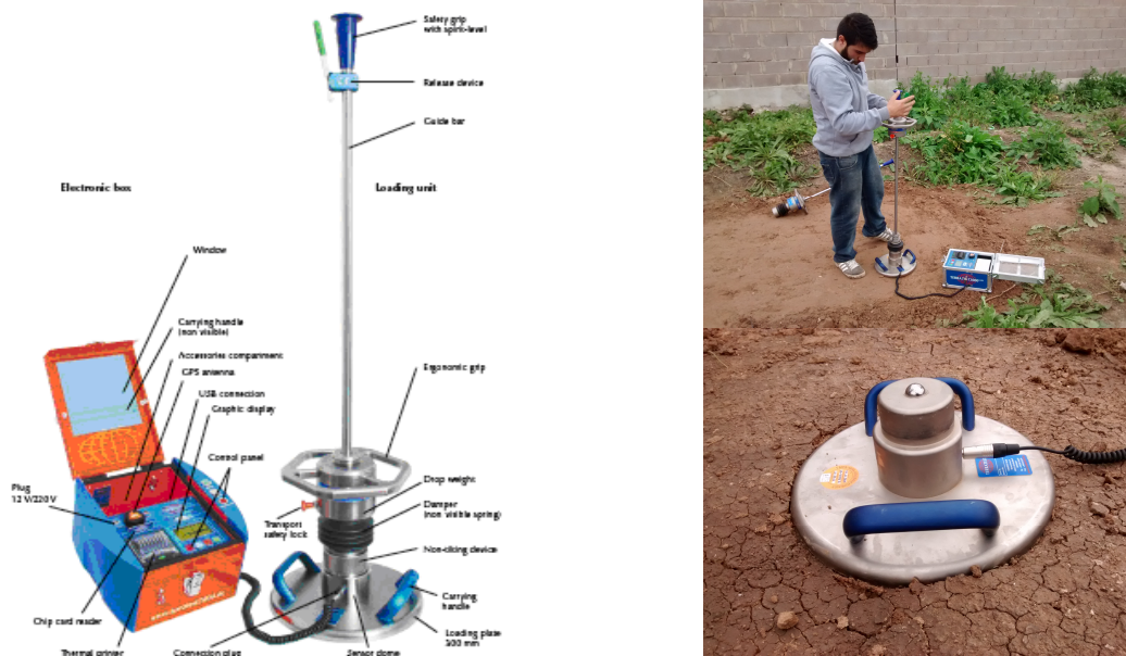
Figura 1. Equipo LWD utilizado y ejecución de ensayo
