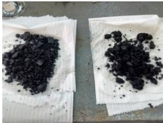
Foto 5. Mezcla asfáltica con AM - 3 con filler cal (A la izquierda mezcla patrón, a la derecha mezcla ensayada)
