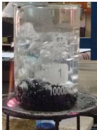
Foto 3. Mezcla asfáltica en fase de ebullición
