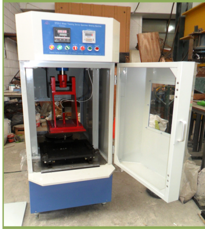
Figura 3. Equipo de compactación
