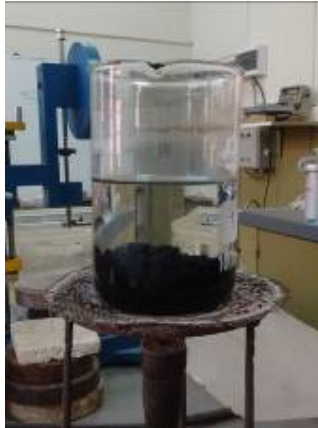
Foto 4. Mezcla asfáltica con AM - 3 filler cal, reposando luego del hervor
