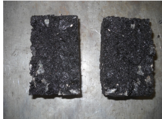
Imagen 1 y 2. Ensayo de tracción indirecta. Vista de la probeta luego del ensayo
