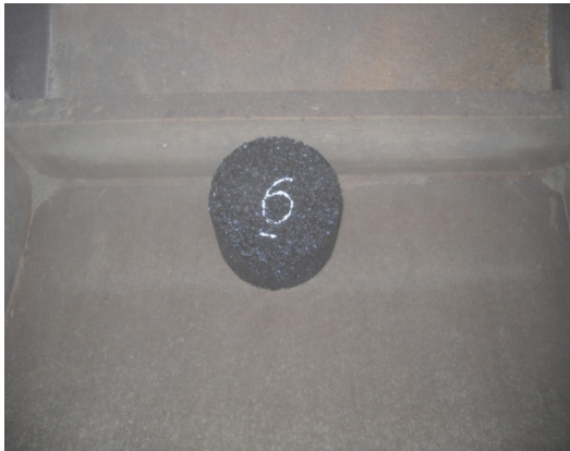
Imagen 3 y 4. Probeta a ensayar dentro del tambor. Probetas ensayadas
