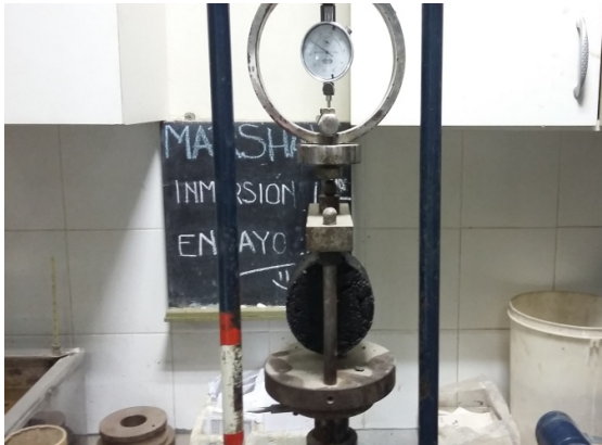
Imagen 1 y 2. Ensayo de tracción indirecta. Vista de la probeta luego del ensayo
