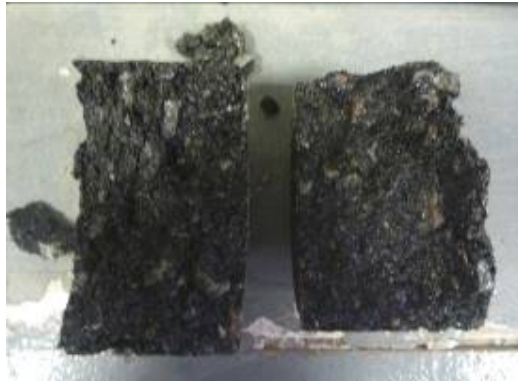
Foto 2. Ensayo de tracción indirecta Sobre mezcla con AM3 con filler cal
