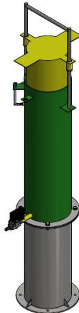
Figura 6.1-Gasómetro para Medición
