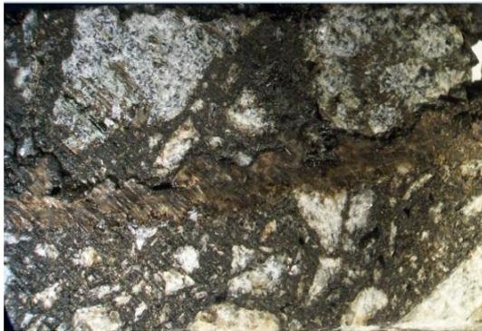
Figura 6. Interfase mezcla asfáltica + emulsión + GPP + emulsión + mezcla asfáltica
