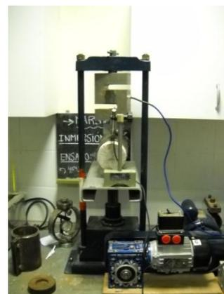
Figura 16. Máquina para el ensayo de corte por flexión LCB
