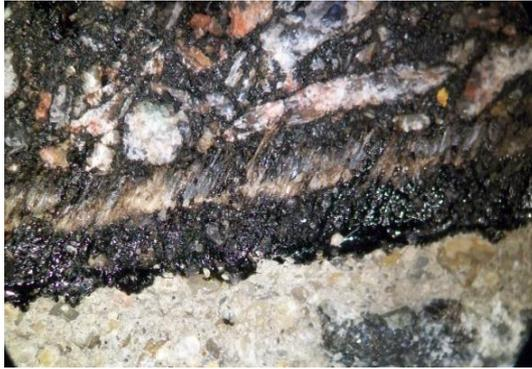
Figura 4. Interfase hormigón + emulsión + GPP + emulsión + mezcla asfáltica
