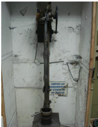
Figura 12. Compactador Marshall y equipo para desmolde de probetas
