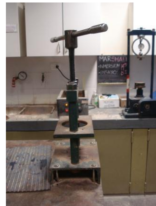
Figura 12. Compactador Marshall y equipo para desmolde de probetas
