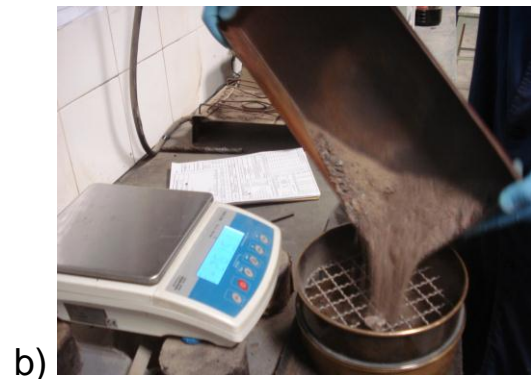
Figura 19. Granulometría de áridos recuperados a) vía húmeda; b) vía seca
