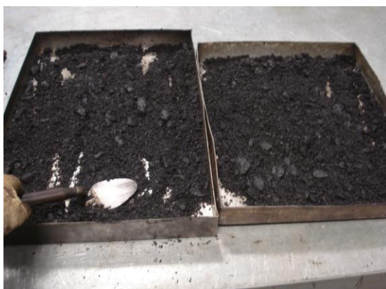
Figura 15. Disgregado y cuarteo de la mezcla para Densidad Rice y Recuperación
