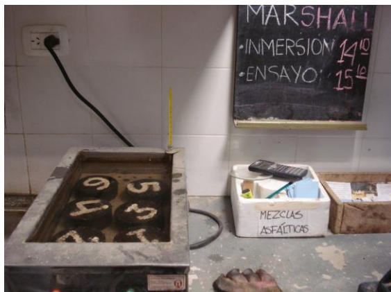
Figura 14. Inmersión en baño de agua termostatzado a 60 °C durante 40 minutos y ensayo de estabilidad/fluencia de las probetas
