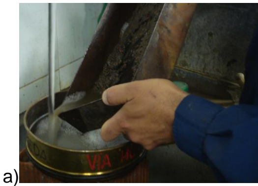
Figura 19. Granulometría de áridos recuperados a) vía húmeda; b) vía seca
