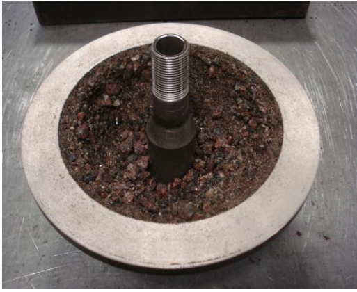
Figura 18. recuperación de finos mediante centrífuga de vasos
