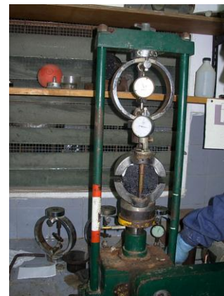
Figura 14. Inmersión en baño de agua termostatzado a 60 °C durante 40 minutos y ensayo de estabilidad/fluencia de las probetas
