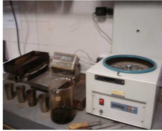
Figura 18. recuperación de finos mediante centrífuga de vasos
