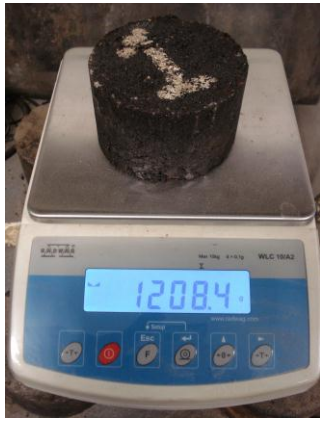
Figura 13. Determinación de peso al aire y peso sumergido de probetas Marshall
