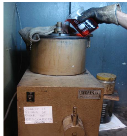
Figura 17. Determinación del contenido de asfalto por centrífuga
