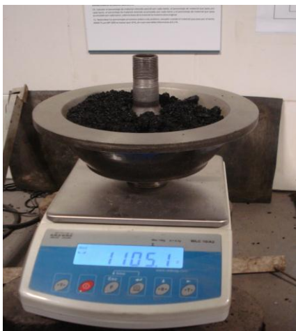
Figura 17. Determinación del contenido de asfalto por centrífuga
