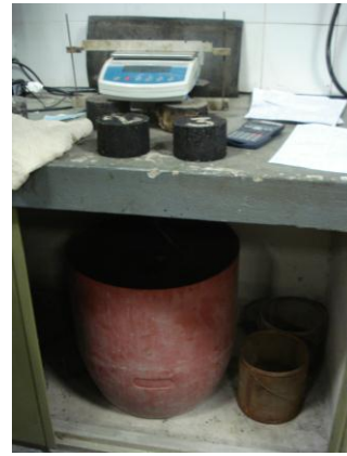
Figura 13. Determinación de peso al aire y peso sumergido de probetas Marshall
