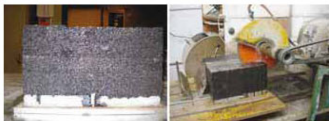
Fotografía Nº 10: Desmolde de la probeta
