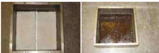
Fotografía Nº 4: Moldes modificados con losas de hormigón y junta de poliestireno
