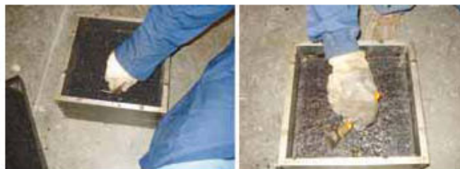
Fotografía Nº 6: Colocación de primera capa de mezcla asfáltica.
