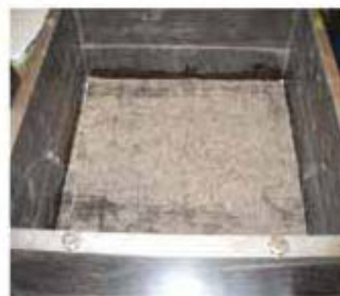
Fotografía N° 1: Geocompuesto con capa adherente en el molde
