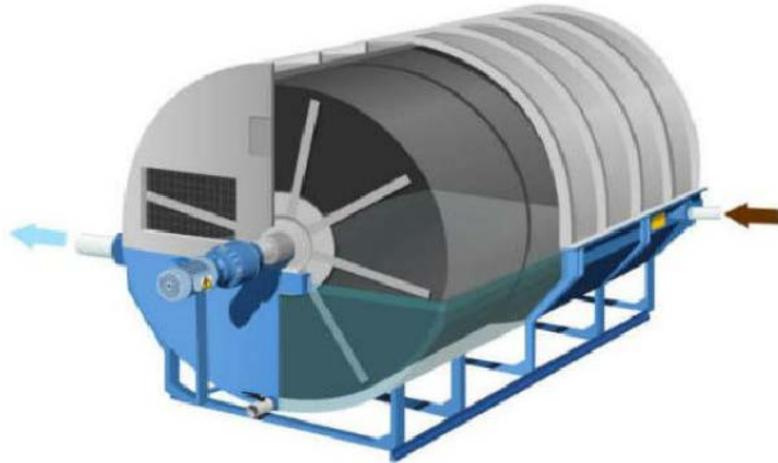
Imagen 9-12: Esquema de un Reactor Biológico Rotativo.
