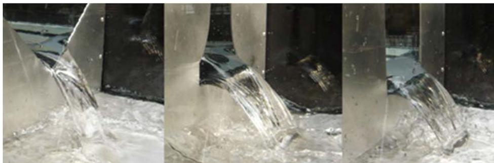
Imagen 12-9: Comparación entre Vertedero triangular, Sutro y rectangular.
