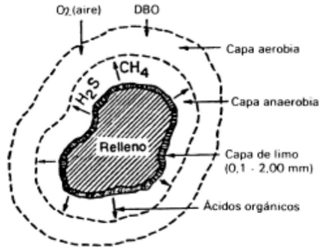
Imagen 9-11: Esquemas de subcapas aerobia y anaerobia de un Filtro Percolador.
