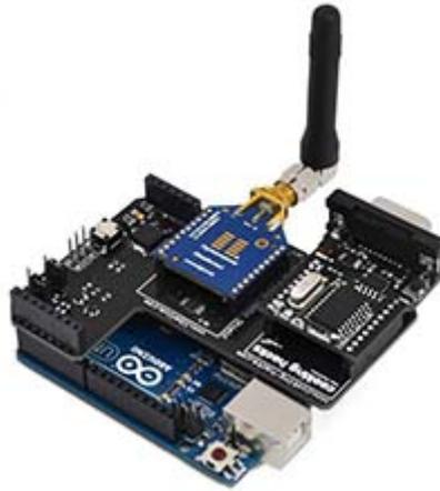
Imagen 7.21: Módulos de comunicación montados.
