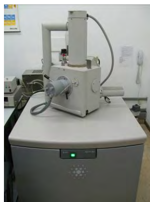
Figura VII.14 Equipo utilizado para las determinaciones EDAX
