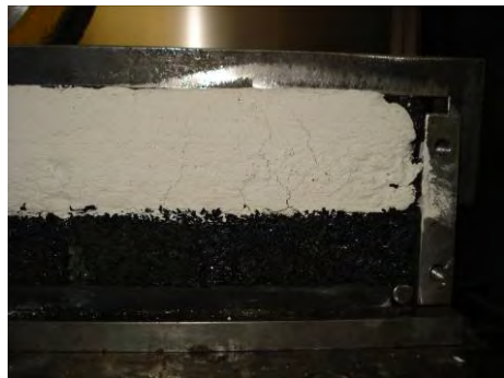
Figura VII.53 Propagación de fisura para el material GR FV
