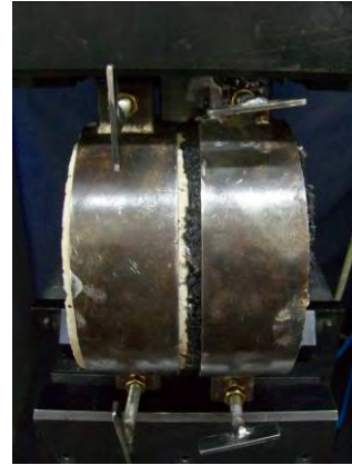
Figura VII.138 Disposición de la probeta en el equipo de ensayo
