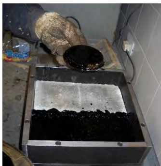
Figura VII.18 Ejecución del riego y colocación del material geosintético
