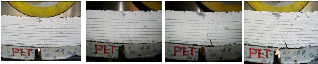
Figura a: Figura b: Figura c: Figura d: Minuto 1109 Minuto 3208 Minuto 4478 Minuto 8564 Ciclo: 29340 Ciclo: 84870 Ciclo: 118460 Ciclo: 226560 h fisura = 5 mm h fisura = 15 mm h fisura = 20 mm h fisura = 30 mm
