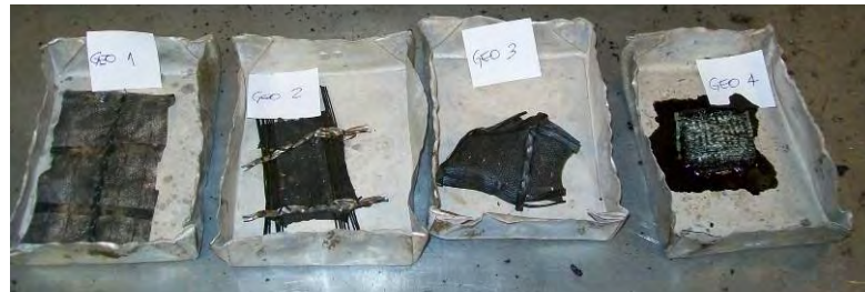
Figura V.13 Observación de muestras luego de ser sometidas a 140 °C por convección en estufa durante una hora
