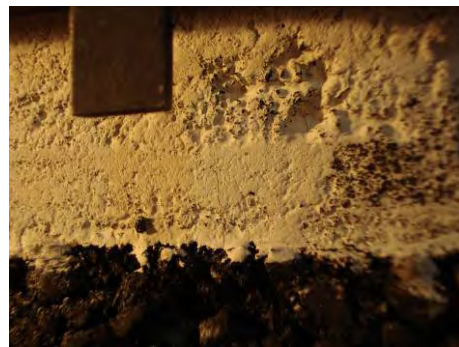
Figura VII.52 Propagación de fisura para el material HSK PET
