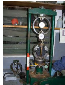
Figura VI.6 Inmersión en baño de agua termostataizado a 60 °C durante 40 minutos y ensayo de estabilidad/fluencia de las probetas
