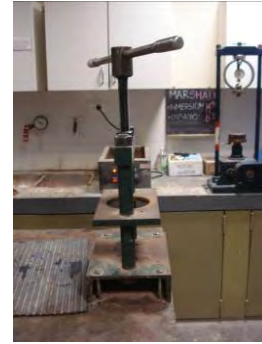
Figura VI.4 Compactador Marshall y equipo para desmolde de probetas
