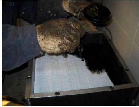
Figura VII.23 Riego sobre el material FM PP (izquierda); compactación de la mezcla asfáltica (derecha)
