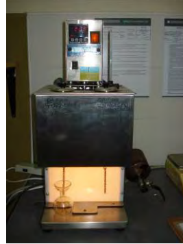
Figura IV.38 Equipamiento para determinar la viscosidad Saybolt Furol
