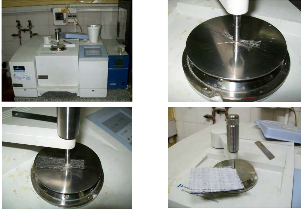
Figura V.65 Equipo utilizado para la determinación de los espectros FT-IR de las diferentes fibras componentes de los materiales geosintéticos
