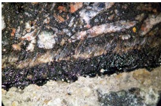
Figura VII.2 Interfase hormigón + emulsión + material FM PP + emulsión + mezcla asfáltica
