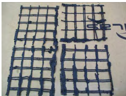
Figura V.28 Muestras recuperadas de la mezcla asfáltica a 180 °C
