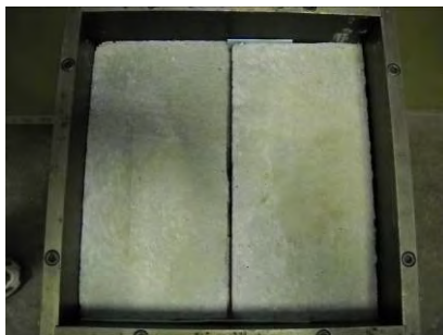
Figura VII.16 Placas de hormigón, sellado de junta
