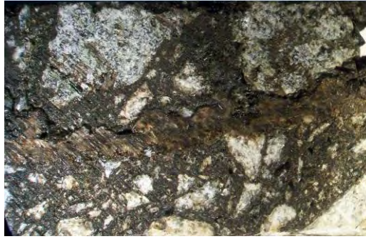
Figura VII.4 Interfase mezcla asfáltica + emulsión + material FM PP + emulsión + mezcla asfáltica
