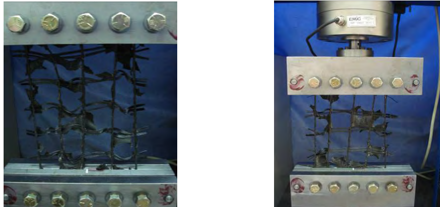
Figura V.18 Ensayo de tracción luego de ser sometido el material a temperatura por convección en estufa durante una hora
