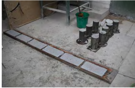
Figura VII.17 Moldeo de probetas y losas (izquierda); ensayo a compresión (derecha)
