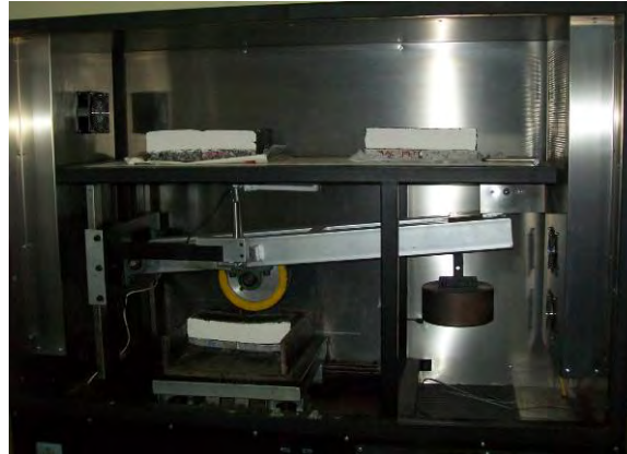
Figura VII.15 Equipo de Wheel Tracking Test empleado
