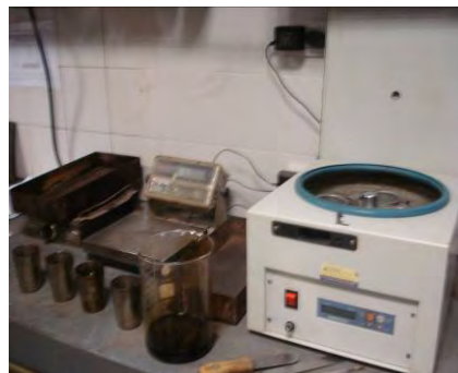
Figura VI.10 recuperación de finos mediante centrífuga de vasos
