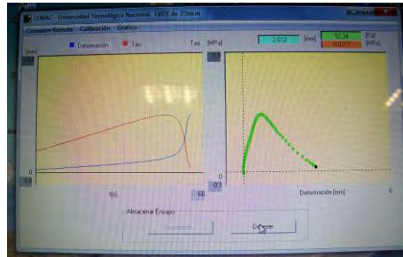
Figura VII.97 Vista del registro del software
