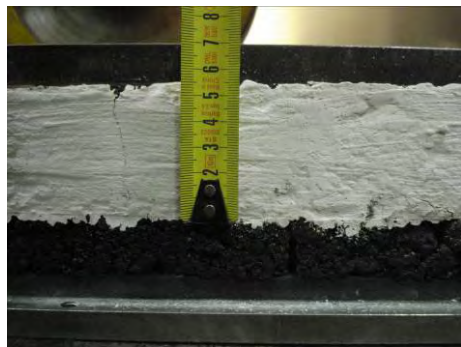
Figura VII.51 Propagación de fisura para el material MAC PET
