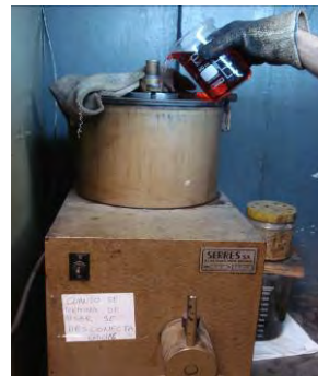
Figura VI.9 Determinación del contenido de asfalto por centrífuga
