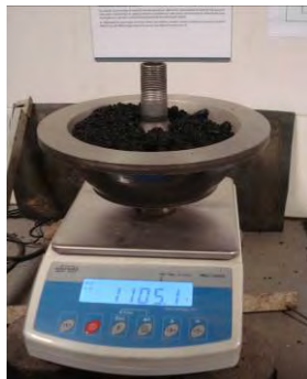
Figura VI.9 Determinación del contenido de asfalto por centrífuga
