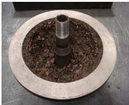
Figura VI.10 recuperación de finos mediante centrífuga de vasos
