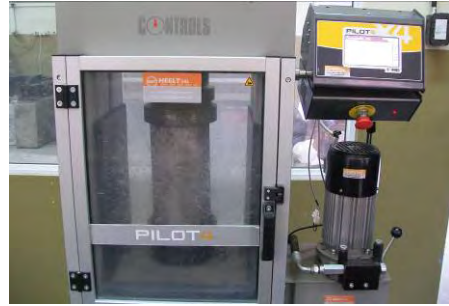
Figura VII.17 Moldeo de probetas y losas (izquierda); ensayo a compresión (derecha)
