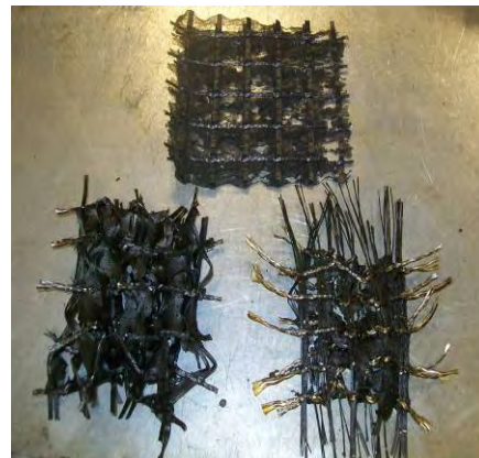
Figura V.17 Muestras después de ser sometidas a 160 °C en estufa durante una hora
