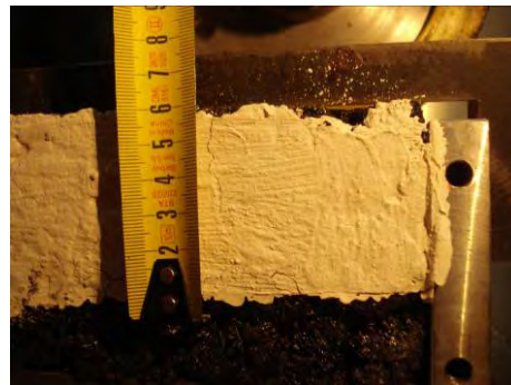
Figura VII.54 Propagación de fisura para el material FM PP
