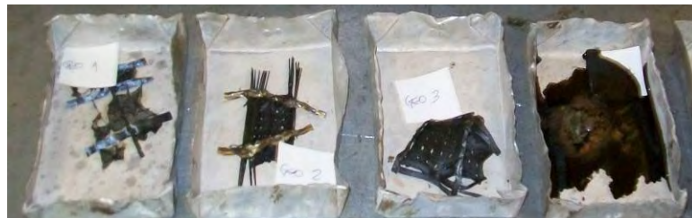
Figura V.14 Observación de muestras luego de ser sometidas a 160 °C por convección en estufa durante una hora
