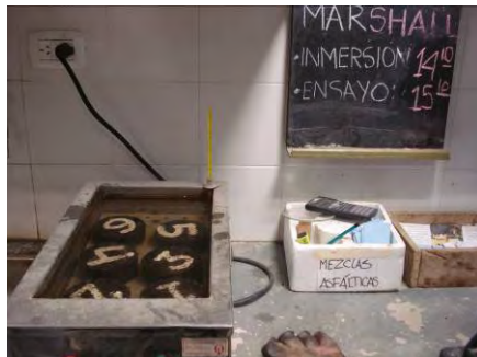
Figura VI.6 Inmersión en baño de agua termostataizado a 60 °C durante 40 minutos y ensayo de estabilidad/fluencia de las probetas
