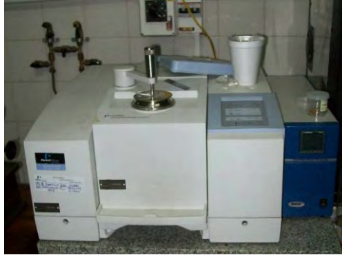
Figura IV.41 Equipo utilizado para la obtención de los espectros sobre las emulsiones asfálticas
