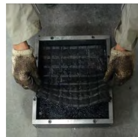
Figura VII.22 Colocación HSK PET
