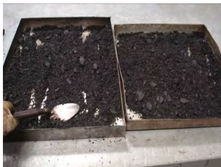
Figura VI.7 Disgregado y cuarteo de la mezcla para Densidad Rice y Recuperación
