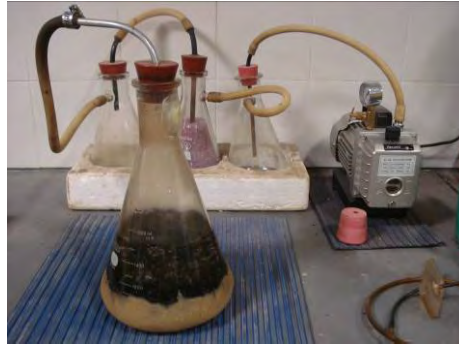
Figura VI.8 Determinación de Densidad Rice
