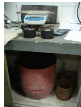
Figura VI.5 Determinación de peso al aire y peso sumergido de probetas Marshall
