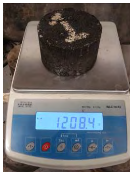
Figura VI.5 Determinación de peso al aire y peso sumergido de probetas Marshall
