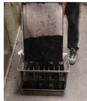
Figura VI.7 Disgregado y cuarteo de la mezcla para Densidad Rice y Recuperación
