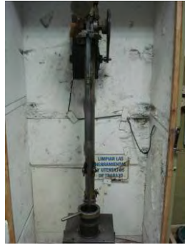
Figura VI.4 Compactador Marshall y equipo para desmolde de probetas
