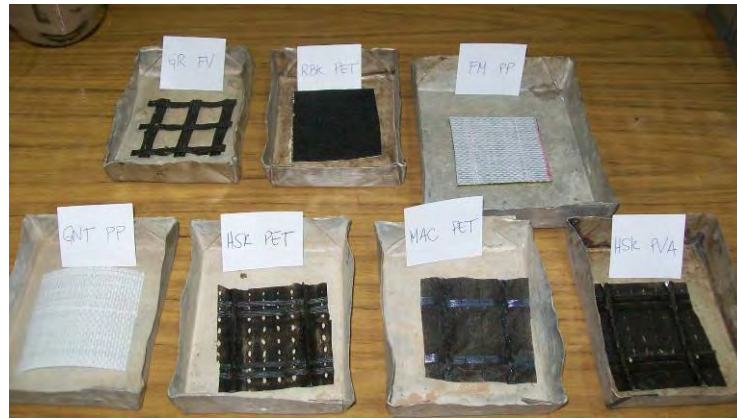
Figura V.12 Muestras antes de ser sometidas a temperatura por convección en estufa
