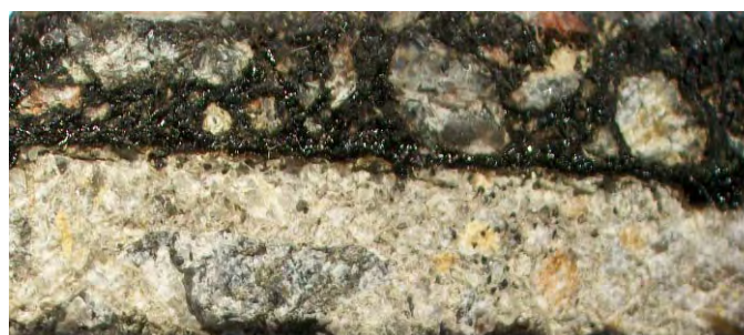
Figura VII.12 Interfase hormigón + emulsión + mezcla asfáltica
