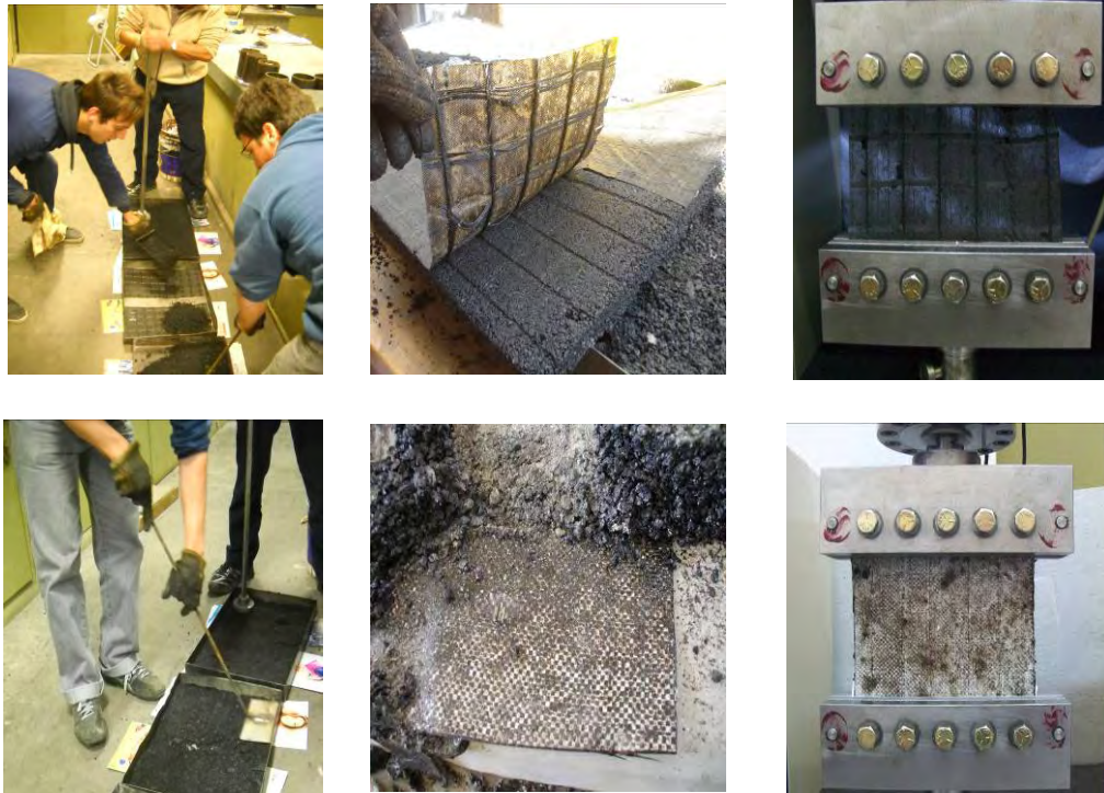
Figura V.19 Ensayo de tracción luego de ser sometido el material a 140 °C y 160 °C por conducción al estar en contacto con la mezcla asfáltica en caliente
