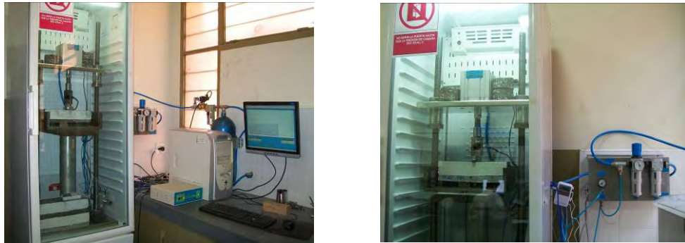
Figura VII.57 Equipo por cargas repetidas implementado
