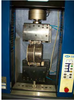
Figura VII.138 Disposición de la probeta en el equipo de ensayo
