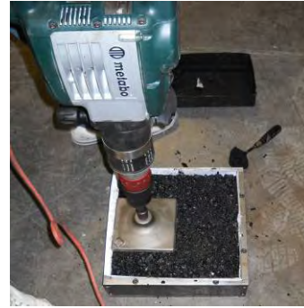
Figura VII.23 Riego sobre el material FM PP (izquierda); compactación de la mezcla asfáltica (derecha)
