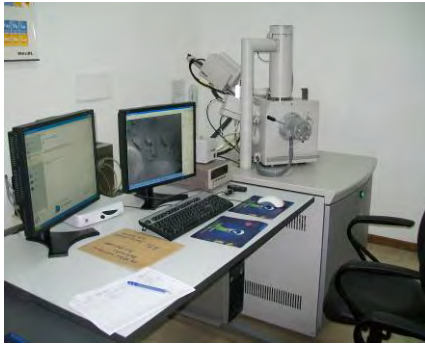
Figura V.60 Equipo utilizado para la obtención de imágenes por SEM
