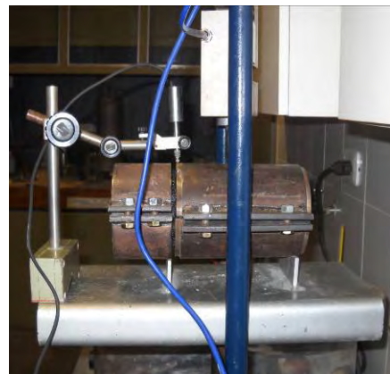
Figura VII.94 vista lateral de máquina para el ensayo de corte por flexión LCB
