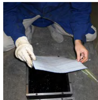
Figura VII.18 Ejecución del riego y colocación del material geosintético
