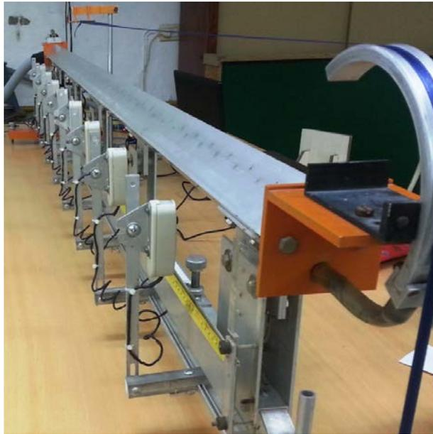
Figura 22 – Montaje de sensores en riel neumático
