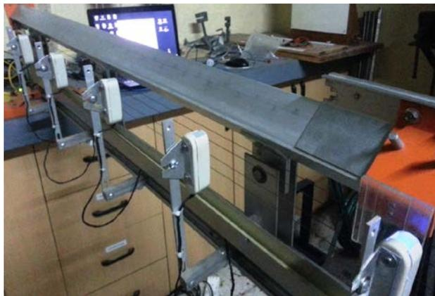
Figura 21 – Montaje de sensores en riel neumático
