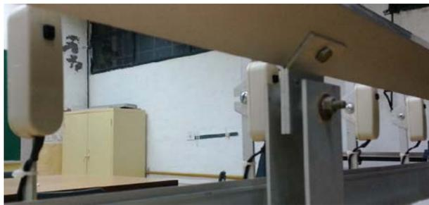
Figura 23 – Montaje de sensores en riel neumático
