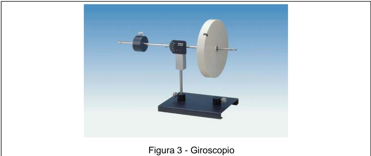
Se utiliza en laboratorio para la determinación experimental del momento de inercia del giróscopo y de la velocidad angular de precesión.
