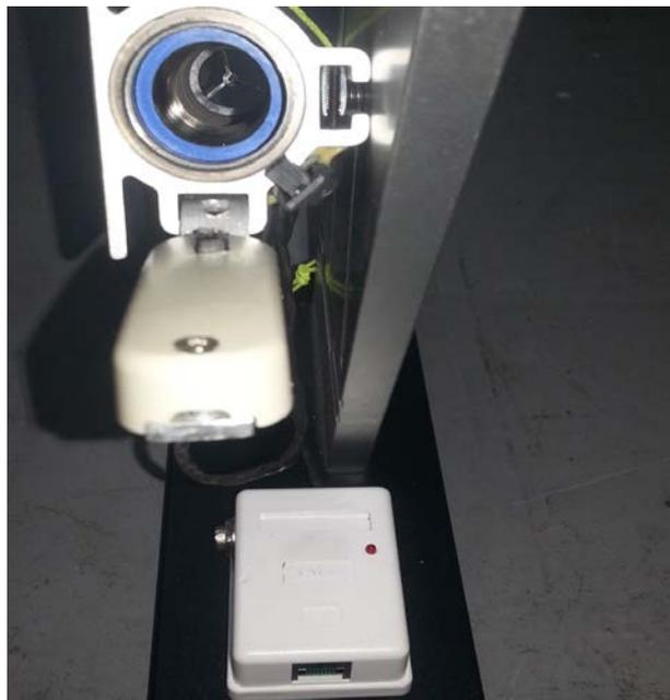
Figura 26 – Montaje de sensores en lanza-proyectiles
