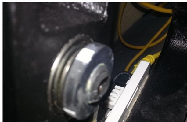
Figura 28 – Rueda con puntos de sensado eje vertical de giroscopio
