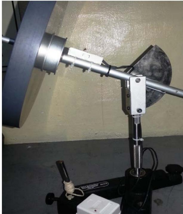
Figura 27 – Montaje de sensores en giroscopio
