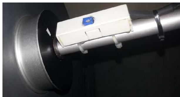
Figura 29 – Montaje de sensor en eje de disco del giroscopio
