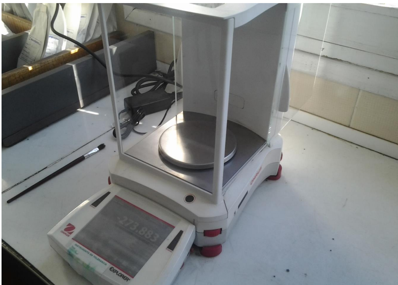
Fig. 35: Balanza de precisión de laboratorio utilizada para pesajes de filtros.
