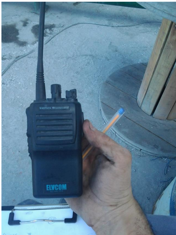
Fig. 69: Radio de UHF utilizada para la comunicación interna con los distintos sectores, entre operarios.
