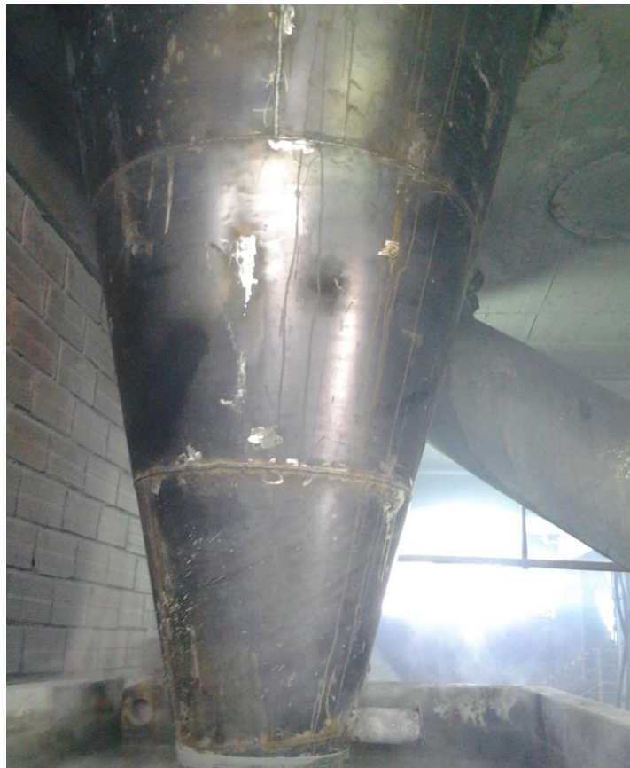
Fig. 50: Ciclón de nuevo diseño en su cono.
