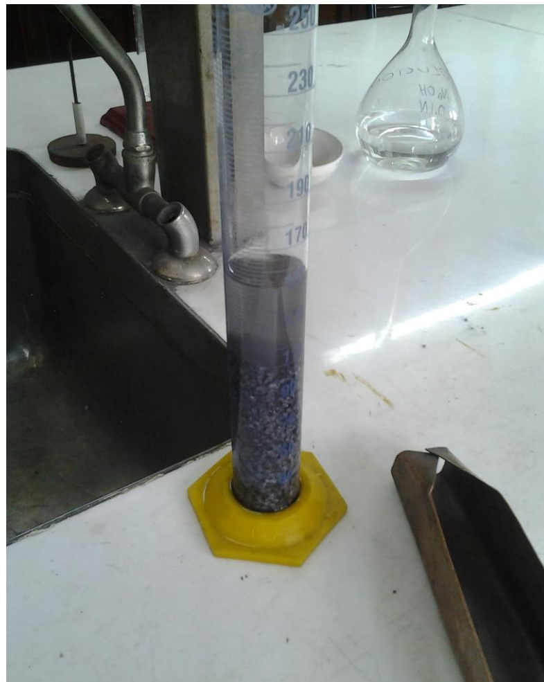
Fig. 68: Determinación química del porcentaje de Sílice en el Ferrosilicio.
