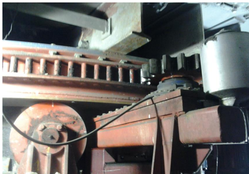
Fig. 55: Sistema de giro del horno NH-2.
