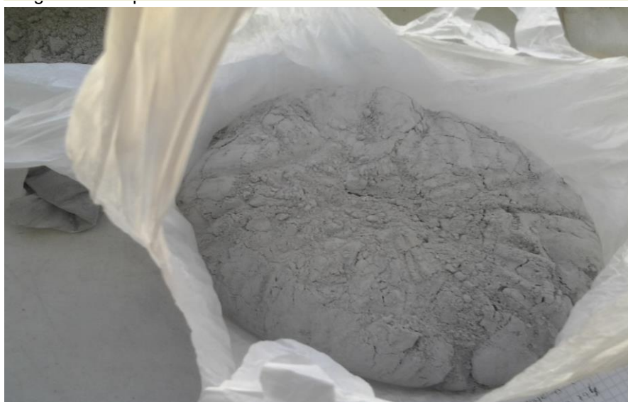
Fig. 39: Microsilice acumulada durante una serie de ensayos, antes ser pesada en laboratorio.
