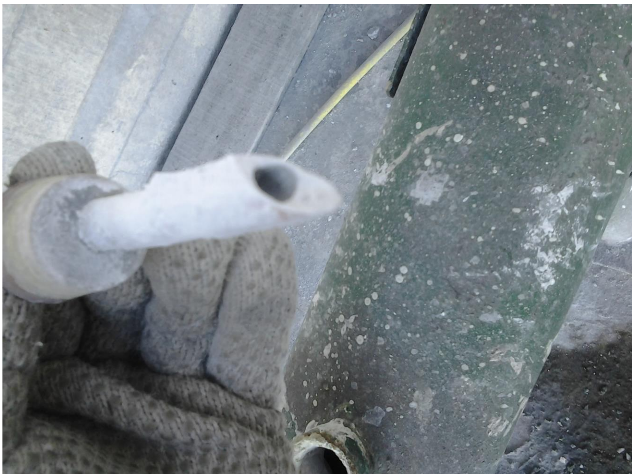
Fig. 27: Muestreador con corte a 45°.
