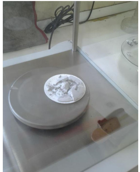
Fig. 32: Filtro de laboratorio introducido en la balanza de precisión. Observar anomalía en acumulación de sólidos.
