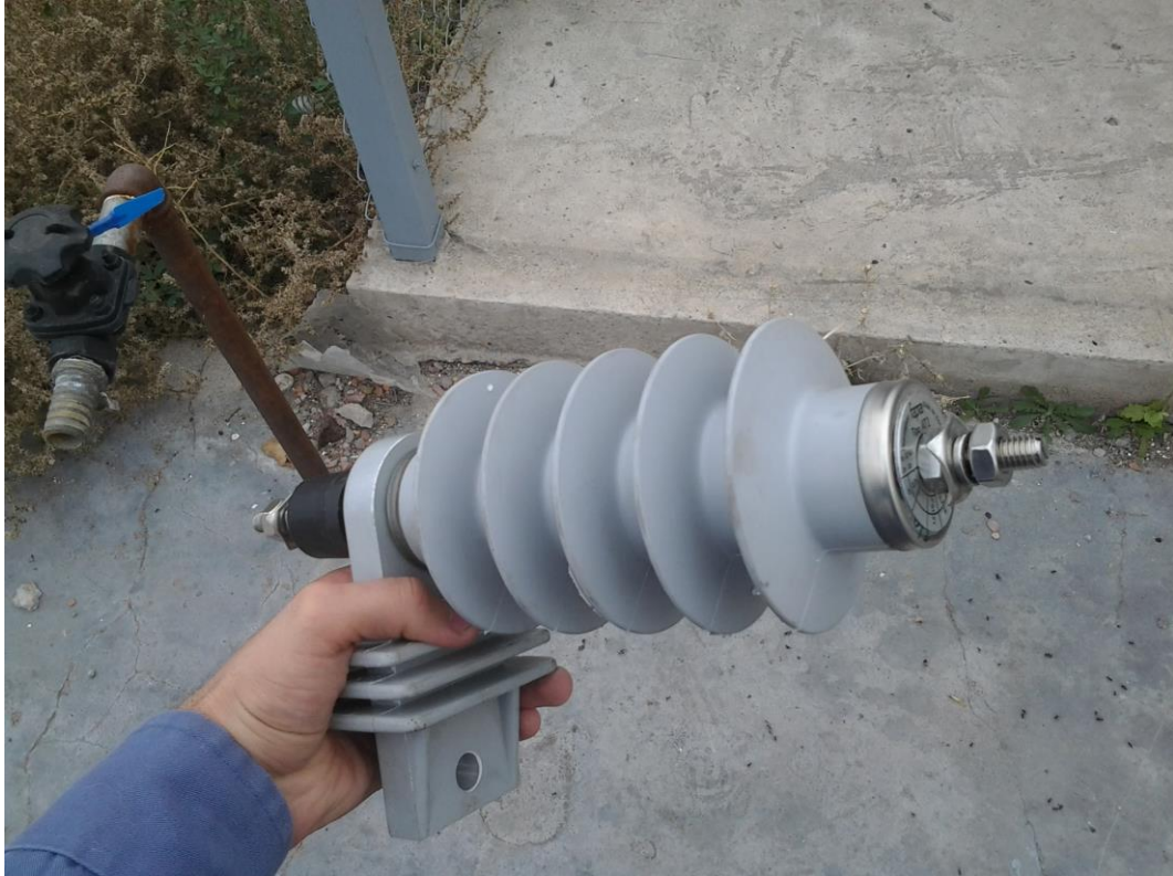
Fig. 58: Descargador de sobretensión que se colocó en reemplazo de los dañados en banco de capacitores.
