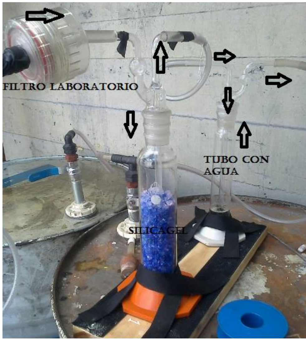
Fig 28: Circuito de muestreo, filtro, silicagel y testigo de paso de gas.
