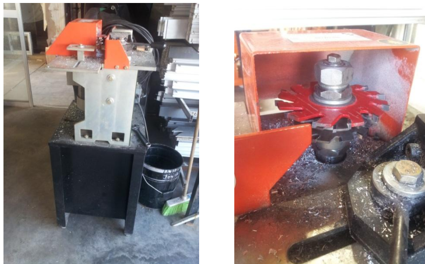
Partículas de aluminio en proceso de fresado / copiado
