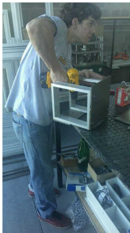
Uso del taladro para el armado de carpinterías
