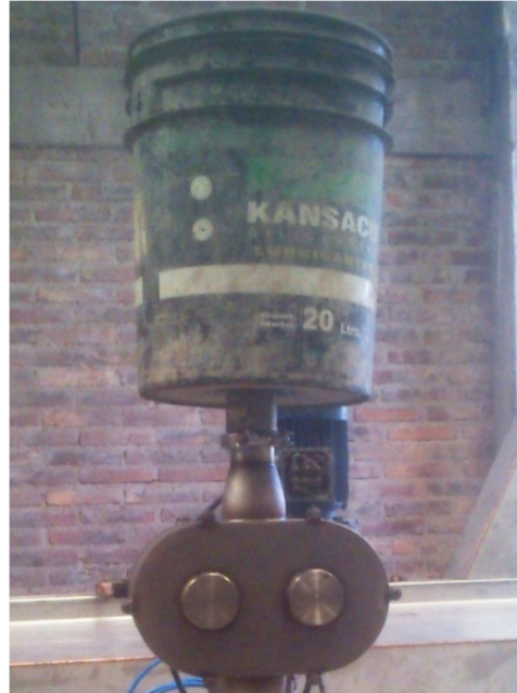
Bomba con tolva provisoria para realizar prueba
