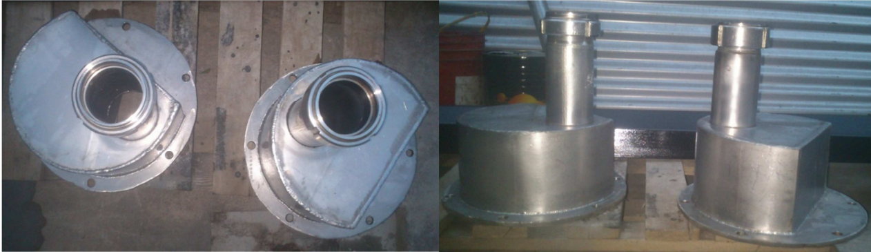
Imágenes de las tapas de entrada y salida terminadas
