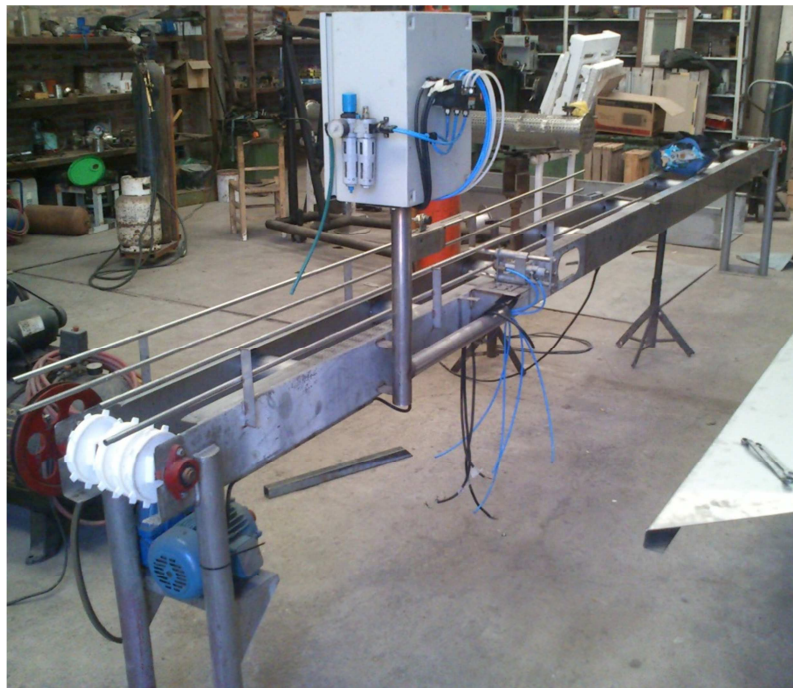
Estructura de la cinta transportadora para la llenadora de latas
