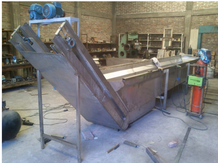
Lagar con el elevador instalado
