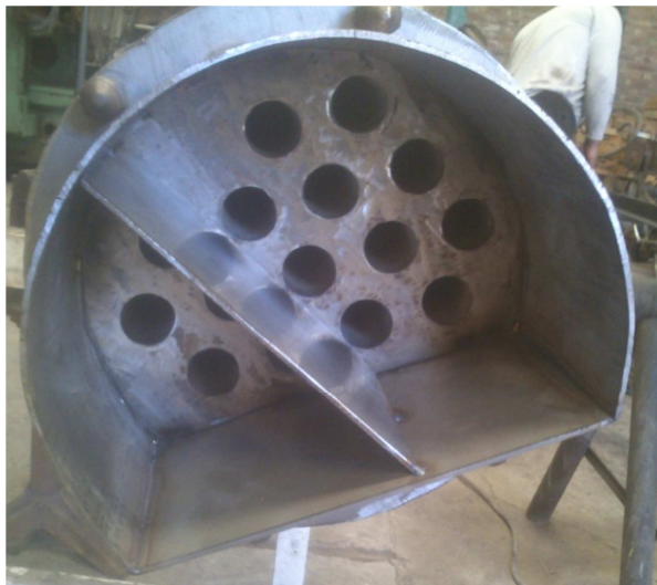
Cuerpo de la tapa de salida con separador interno
