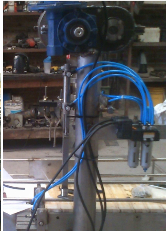
Vista superior y lateral de la disposición y ubicación de electroválvulas y unidad FRL
