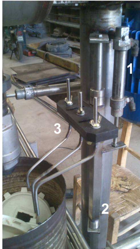
Sensor de electrodos con sistema de accionamiento neumático
