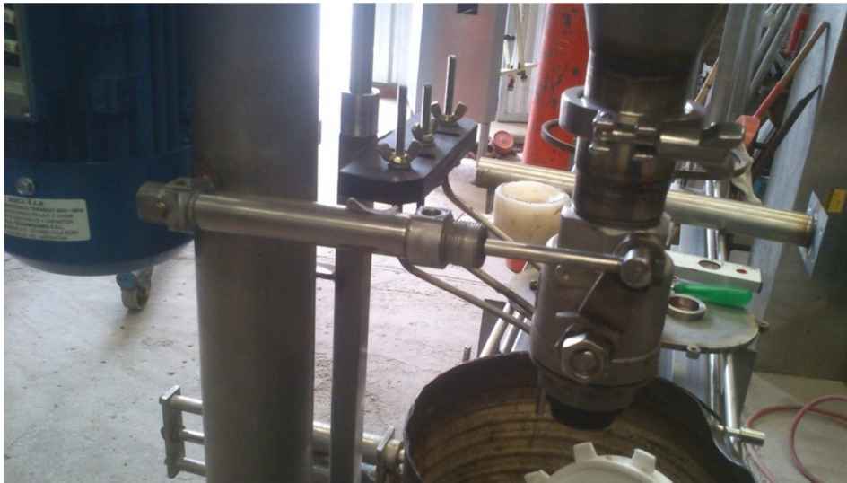
Cilindro neumático vinculado a la válvula globo
