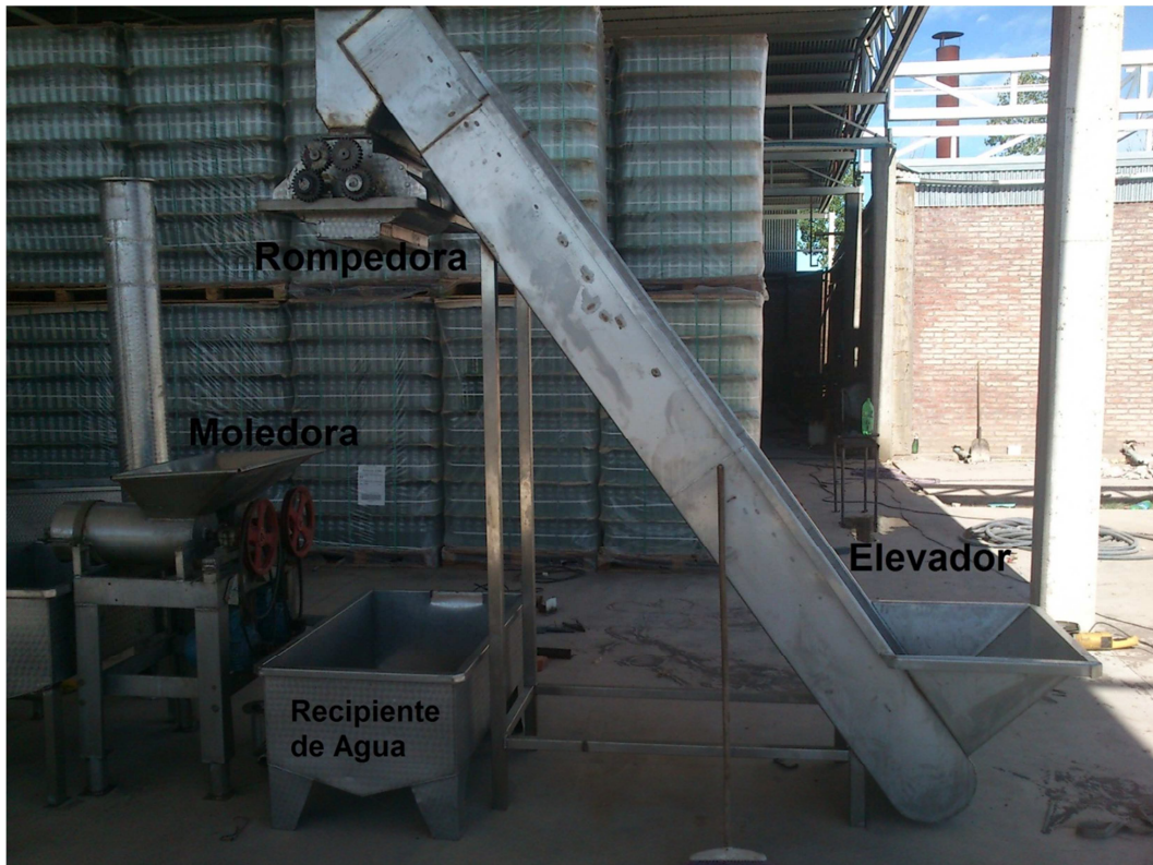
Elevador y rompedor terminados y colocados en la línea
