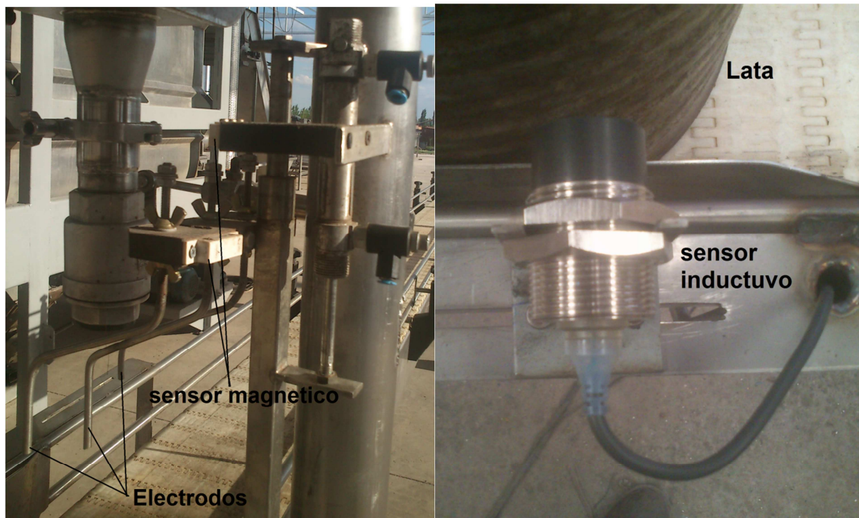
Disposición y ubicación sensor electrodo y magnético
