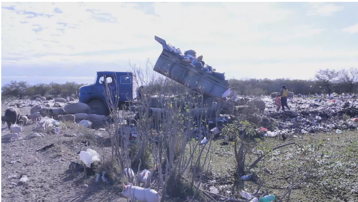
Figura 2.36 | Camión volcador vertiendo los RSU al predio del Basural a Cielo Abierto. Fuente: Captura de pantalla del documental “Cielo Abierto”, de la Asociación Civil Tramatierra.-
