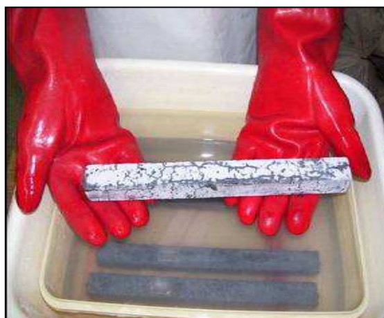
Figura 3: Fisuración en la barra de mortero
