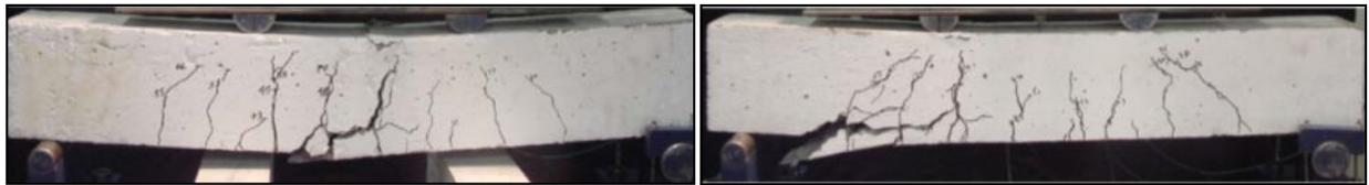
Figura 4.7: Viga EBR con dos capas de tejidos (izquierda) y viga EBR con tres capas de tejidos (derecha) [26].
