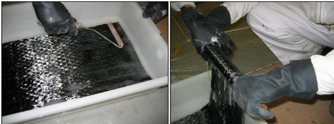
*Figura 6.22: Impregnación del tejido en resina y enrollado en los listones de madera [12].*
