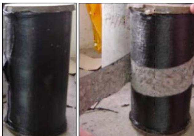
*Figura 4.45: Falla de la probeta confinada con PRFC.*
