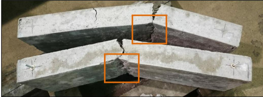
*Figura 4.38: Falla por agotamiento del hormigón.*
