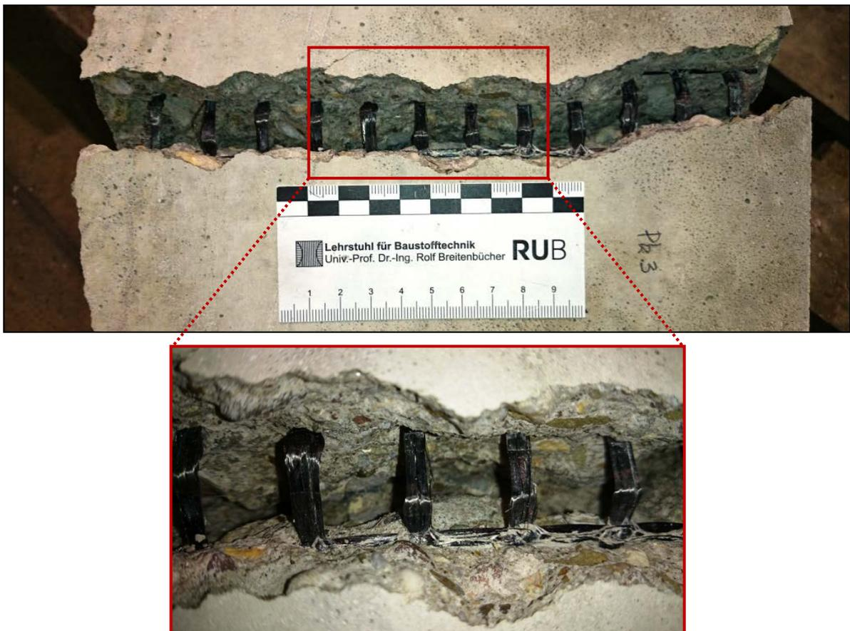
Figura 4.37: Viga reforzada con fibras luego de la rotura.
