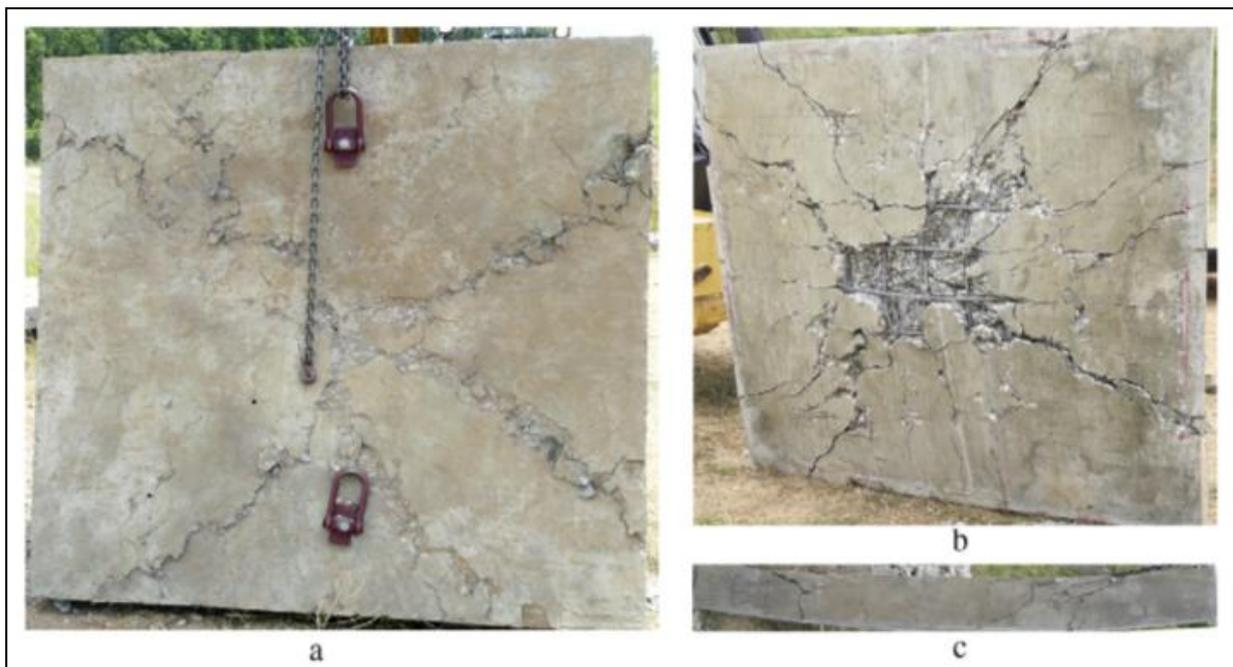
*Figura 4.21: Fibras B, panel 1; a) superficie expuesta, b) superficie inferior, c) de costado [28].*
