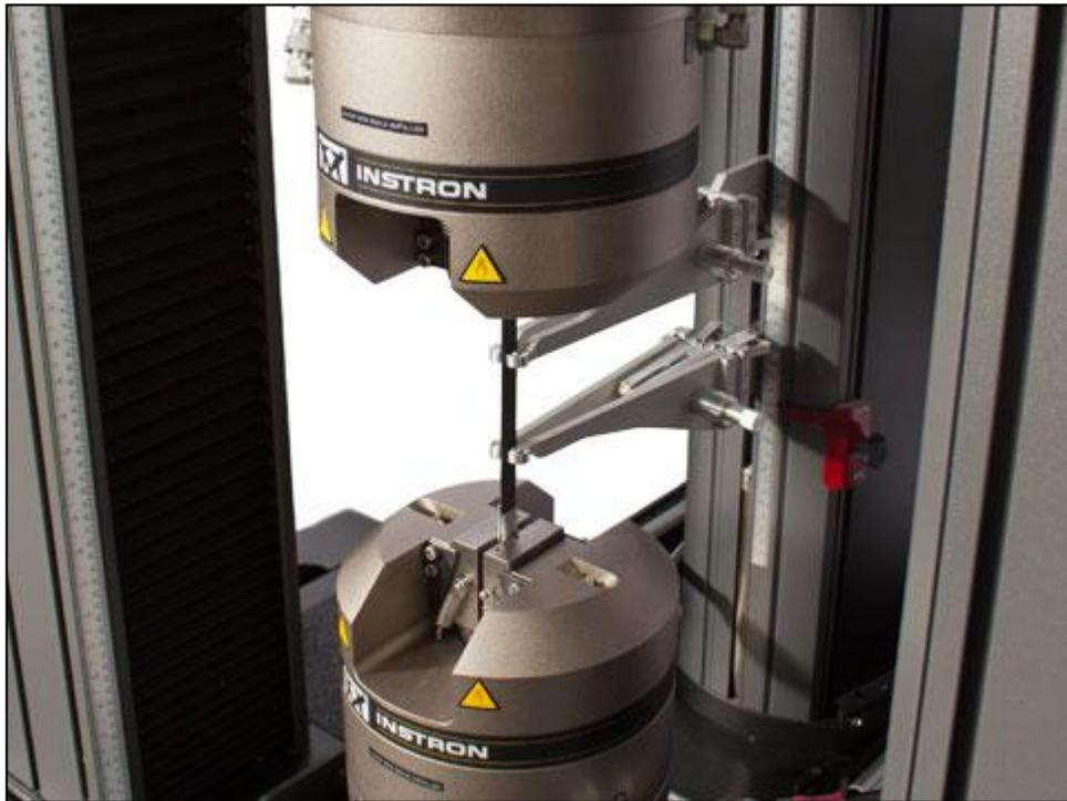
*Figura 3.4: Ensayo de tracción utilizando un extensómetro automático.*
