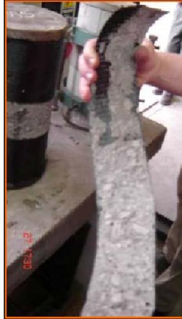
*Figura 4.47: Rotura de la interfase material compuesto – hormigón.*
