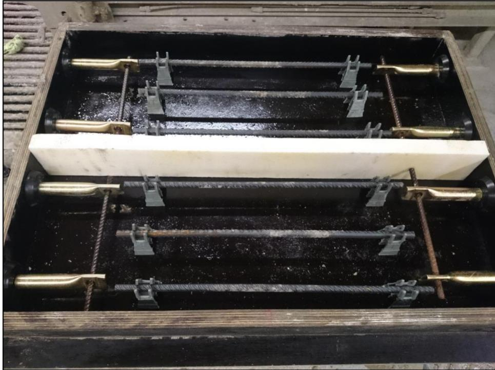
*Figura 4.32: armado de las vigas con barras de acero  $\phi$  10mm.*
