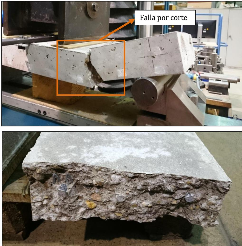
Figura 4.35: Viga reforzada con barras de acero. Momento de la falla (arriba). Falta de continuidad de las armaduras (abajo).
