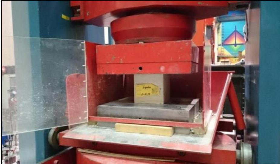
*Figura 4.27: Ejecución de un ensayo a compresión.*
