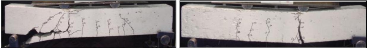
Figura 4.6: Viga EBR con tres láminas (izquierda) y viga EBR con una capa de tejidos (derecha) [26].
