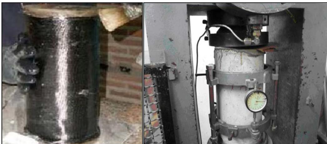
*Figura 4.44: Aplicación de refuerzo (izquierda) y montaje usado en los ensayos (derecha) [44].*
