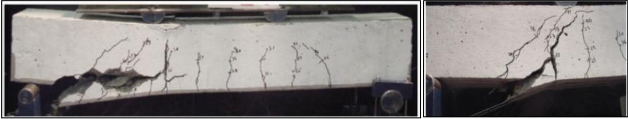
Figura 4.5: Viga NSM con dos o tres láminas (izquierda) y viga EBR con dos o tres láminas (derecha) [26].
