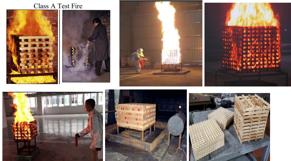
Figura N°24 Test para fuegos clase A
