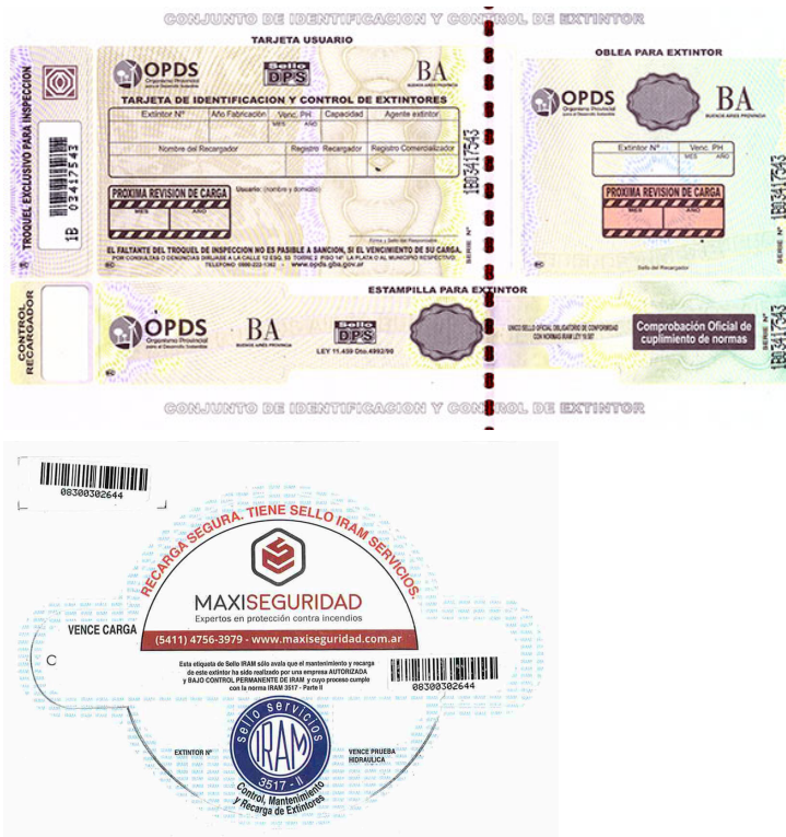
Figura N°55 Calco de inspección
