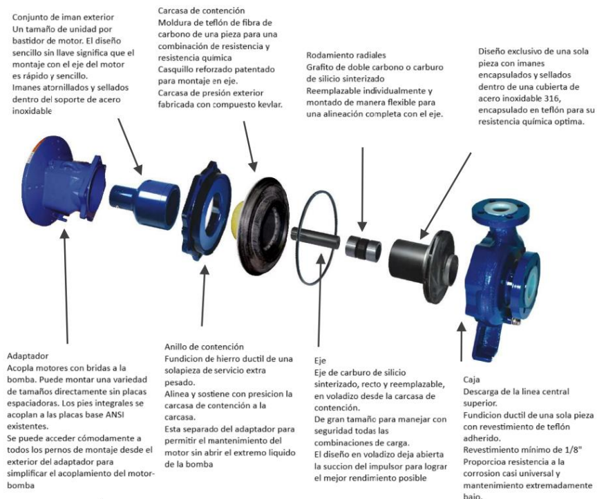
Figura 50: Aspectos y partes de la bomba.
