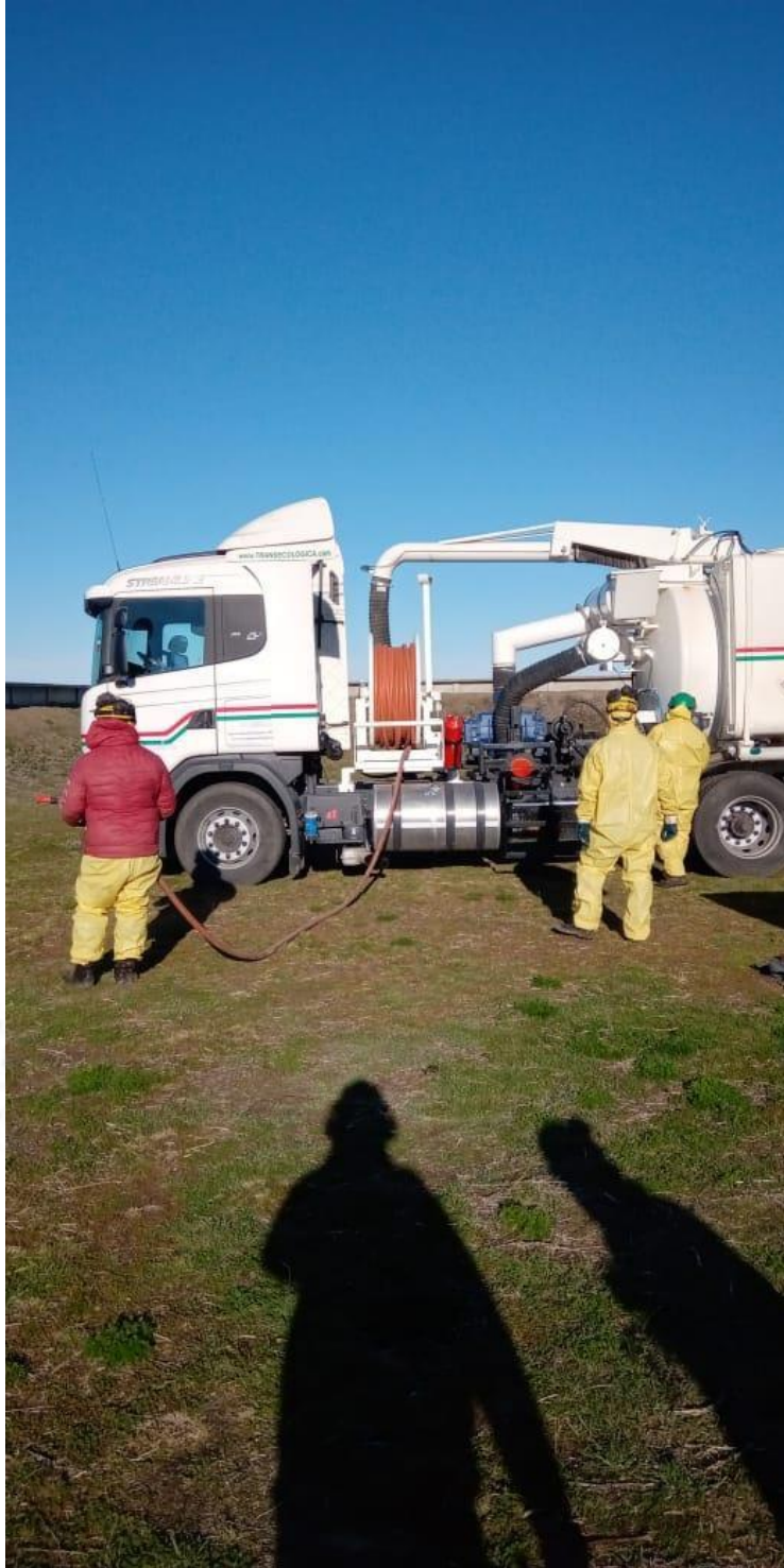
Foto 4.Retirando manguera para depósito de sedimentos.
