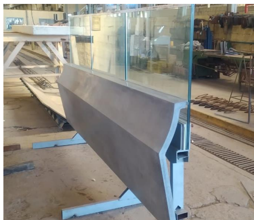
Figura 3 – Prototipo escala real placa GRC, bastidor y vidrio balcón.
