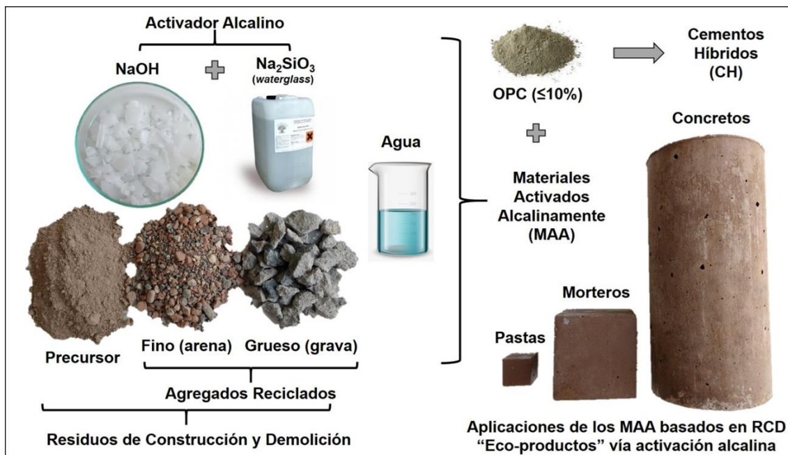
Figura 2 – Proceso de activación alcalina de los RCDs.
