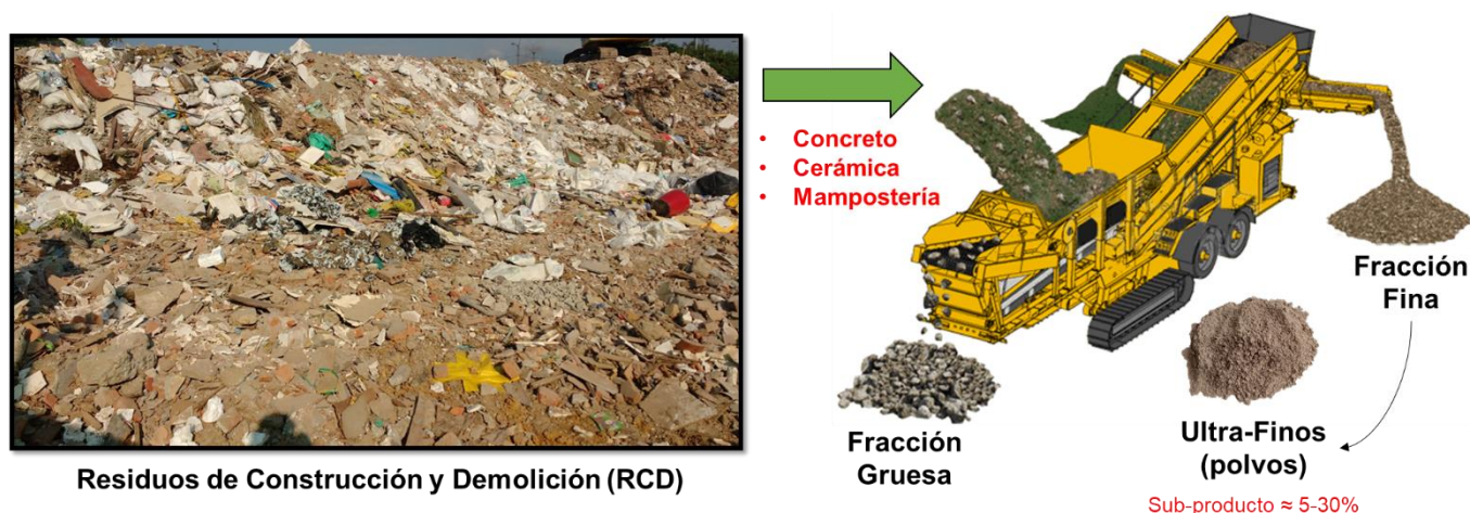
Figura 1 – Procesamiento de los RCDs y obtención de materias primas: 1) fracción gruesa, 2) fracción fina y 3) fracción ultra-fina (sub-producto tipo polvo).
