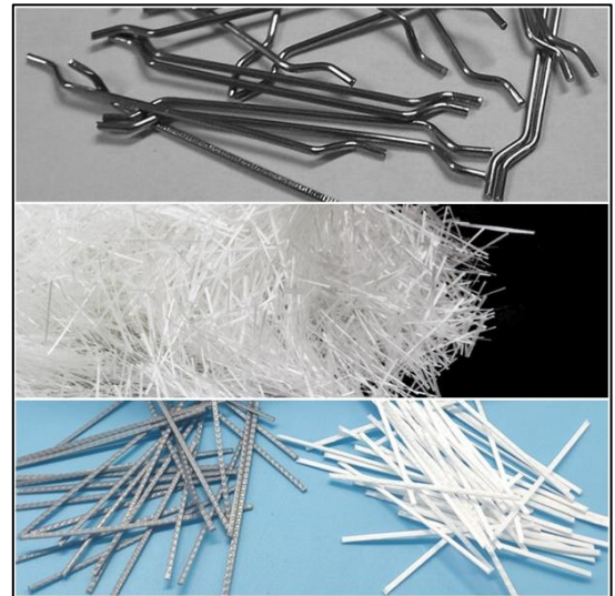
Figura 2 – Fibras metálicas (superior), fibras de vidrio (medio), fibras sintéticas (inferior).
