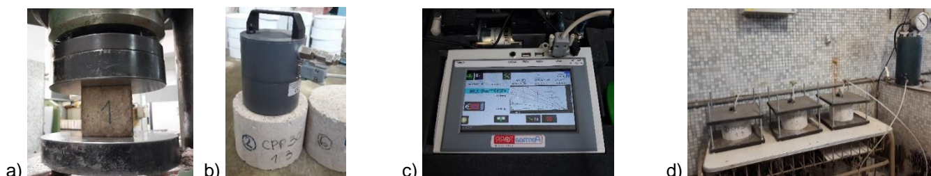
Figura 1 – Ensayos en probetas de morteros: a) resistencia a compresión, b) y c) permeabilidad al aire, d) penetración de agua
