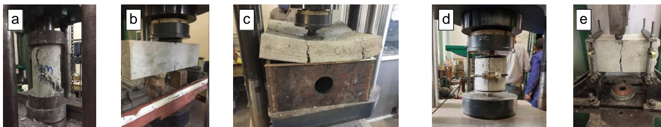
Figura 1. Ensayos de (a) compresión (b) flexión de vigas (c) flexión de paneles (d) Barcelona (e) impacto.
