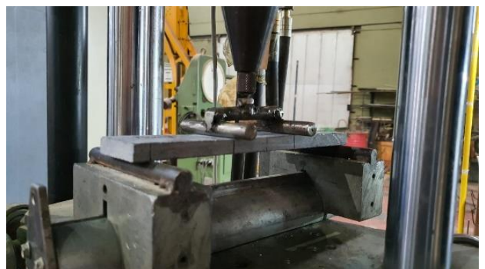
Figura 2 – Ensayo de flexión completa según EN 1170-5
