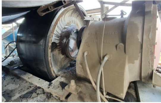
Fig. 1. Se ve la rotura provocada en el árbol.
